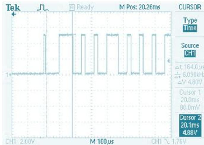
Fig. 4.11 Secuencia de bits de sensor de pulso
