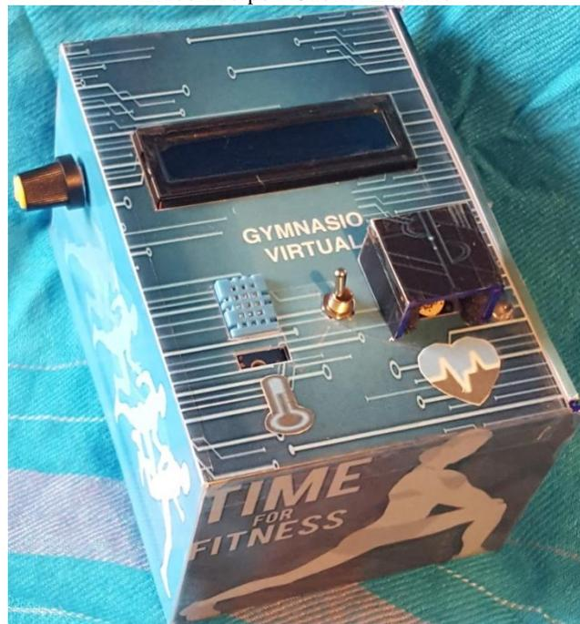
Fig. 4.33 Sistema de control y monitoreo de hipertermia y deshidratación
