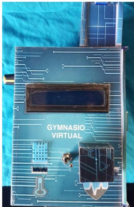
En la pantalla LCD se visualiza mensajes de bienvenida hacia el gimnasio virtual, establece un tiempo programado de espera para obtener la primera medición del sensor.
