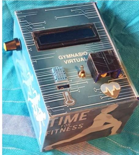
El dispositivo se compone de un sensor de temperatura y humedad además de un sensor de pulso cardiaco, para determinar dichas variables físicas y transformarlas en variables eléctricas y ser visualizadas en una pantalla LCD. Para el uso correcto del dispositivo el usuario debe tomar las medidas permitentes y evitar daños por humedad.
