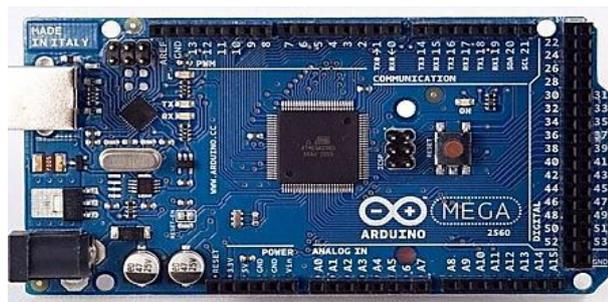
Fig. 4.9 Arduino mega 2560
