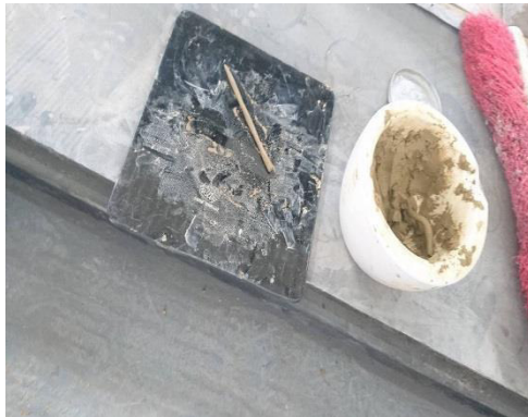
Ensayo de Límites Atterberg
