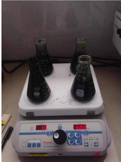
Figura 1. Estudio de influencia de las condiciones de operación en la hidrólisis de Spirulina. La plancha de calentamiento mantuvo a la misma temperatura a los 4 matraces y con una velocidad de agitación constante.
