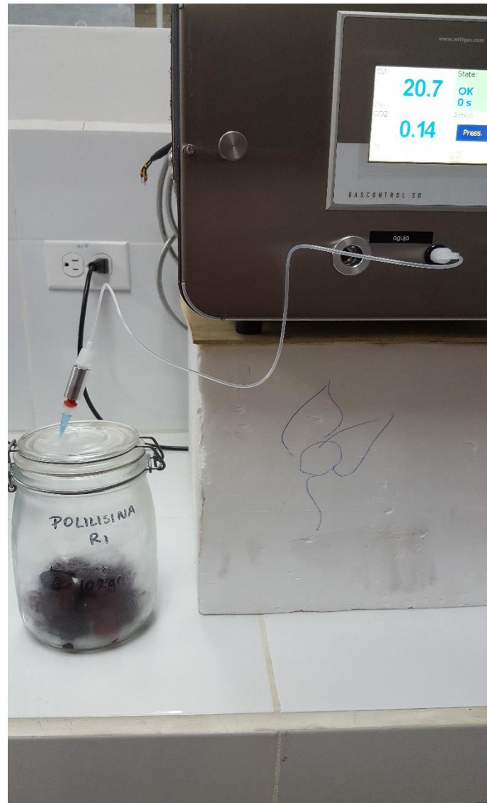
Figura 17. Medición de concentración de gases.
