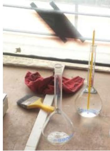
Toma de temperatura del agua y peso del picnómetro con agua.
