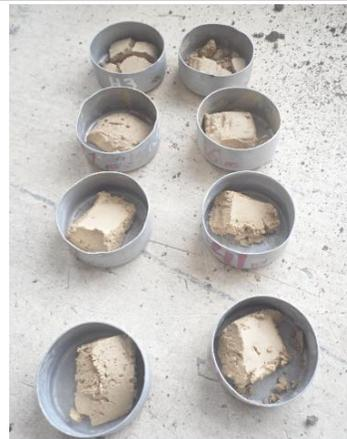
Muestra de suelo para el contenido de humedad para el límite líquido.
