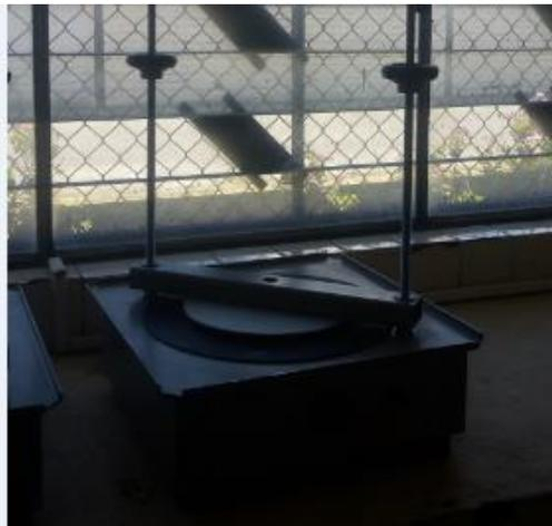
Maquina Tamizadora para el ensayo de la granulometría
