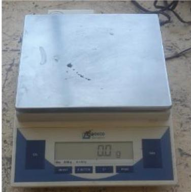
Balanza electrónica de precisión
