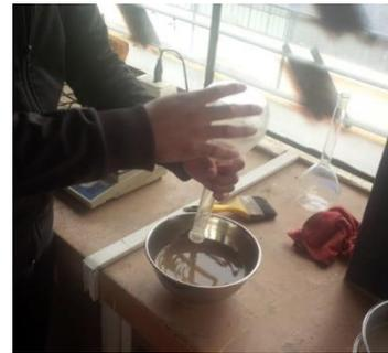
Vaciado del picnómetro y toma del peso en un recipiente de aluminio.
