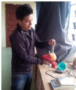
Agitar el picnómetro con el fin de sacar el aire del interior del picnómetro.
