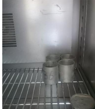
Colocar las muestras en el horno por 24 horas y realizar los cálculos necesarios.
