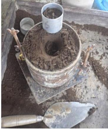
Tomar la muestra de la superficie y de la base del molde para graficar la curva del contenido de humedad.
