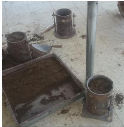
Cada parte colocar en el cilindro y realizar la compactación.
