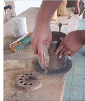
Preparación del molde para colocarlo en la máquina de compresión simple.
