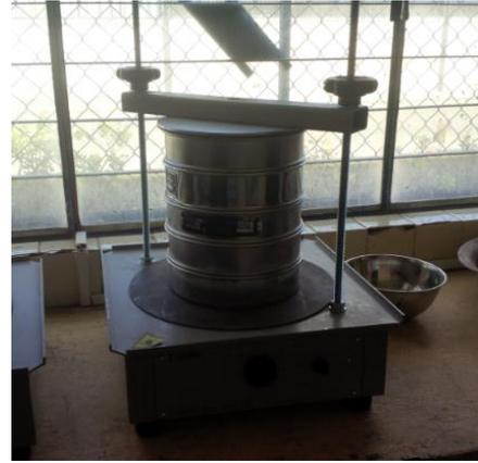
Colocación de los tamizes incluido la muestra de suelo en la mesa vibratoria.
