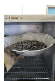
Muestra de agregado grueso colocada en el horno
