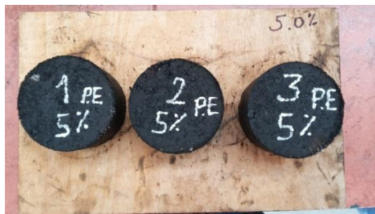
Gráfico N° 29. Briquetas asfálticas modificadas con polímero (P.E)
