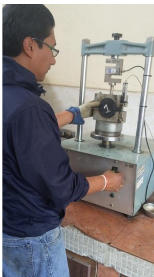
Gráfico N° 20. Ensayo marshall para briquetas asfálticas tradicionales.
