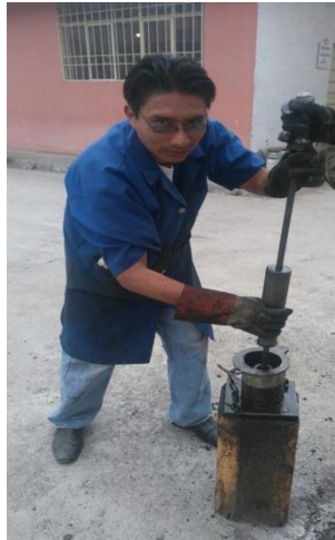
Gráfico N° 28. Compactación de la mezcla modificada con polímero (P.E)
