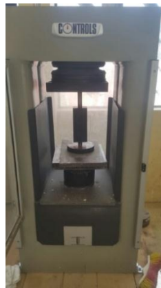
Figura 53. Molde compactado en la máquina de compresión
