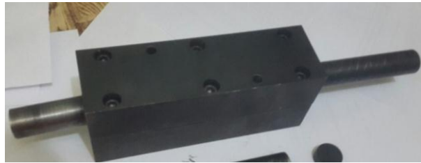
Figura 52. Molde lleno de polvo metálico
