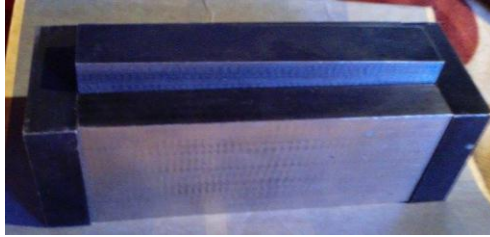
Figura 60. Molde lleno del polvo metálico
