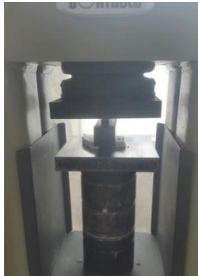
Figura 61. Compactación del molde
