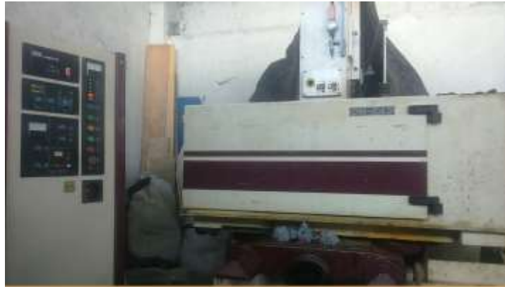
Figura 4. 7. Máquina para electroerosión por penetración CHEVALIER DM- 540.
