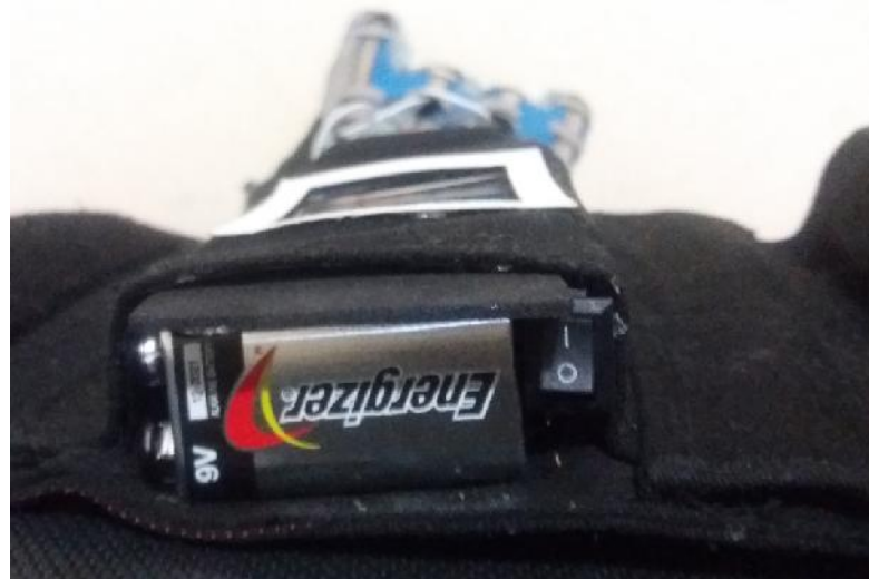
Figura N° A.5 Ranura para la batería de 9v
