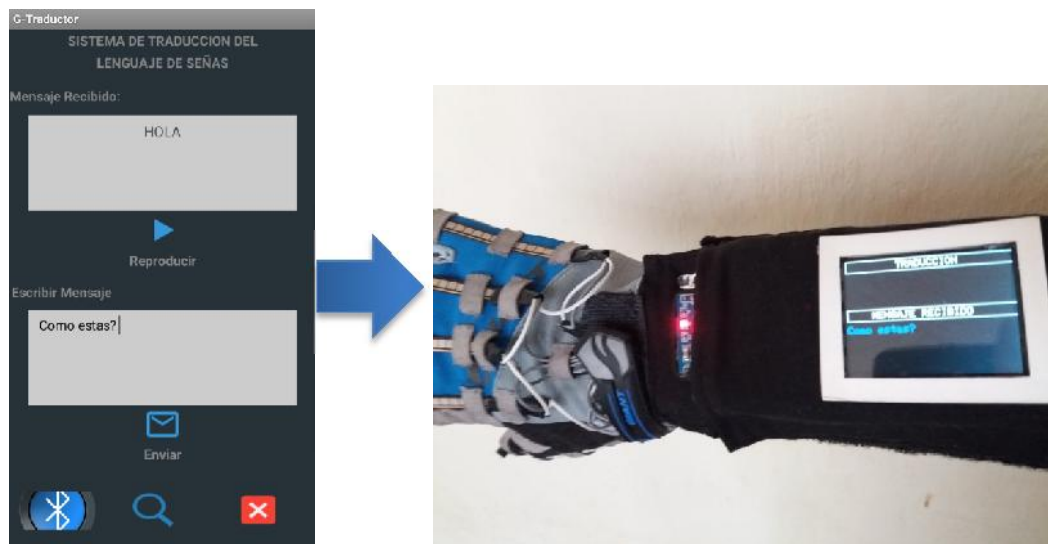
Figura N° A.14 Recepción de mensajes desde el dispositivo móvil al guante
