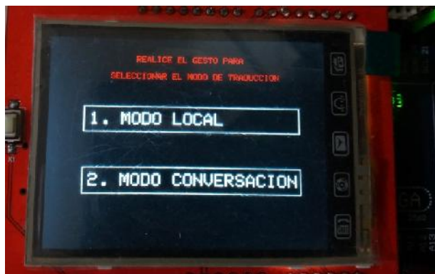
Figura N° 18. Pantalla TFT con la interfaz del sistema
