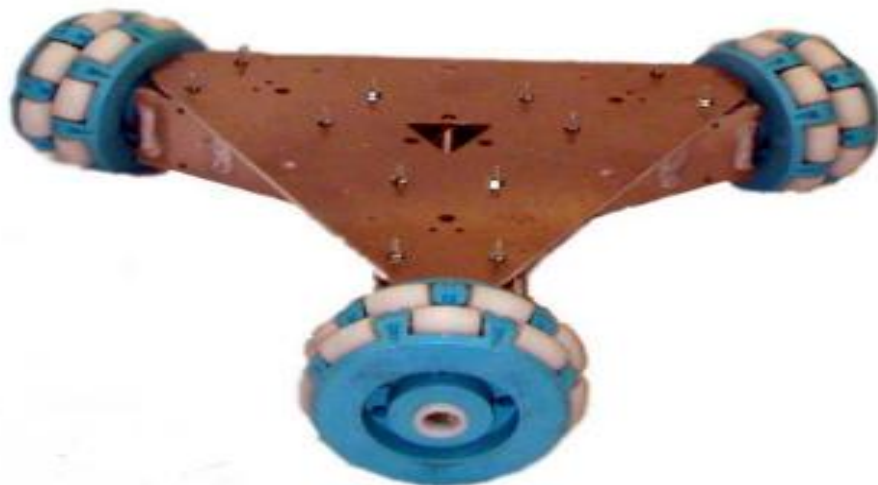
Figura 2.20: Plataforma Omnidireccional de tres ruedas. [41]
