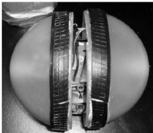
Figura 2.5: Diseño de dos hemisferios controlados independientemente.[5]
