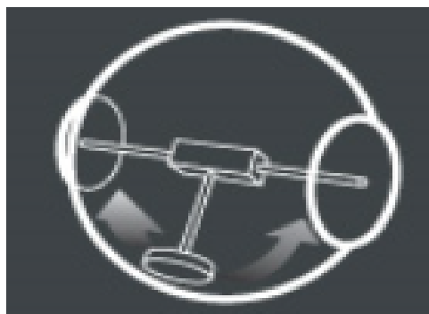
Figura 2.3: Mecanismo interno basado en el diseño pendular.[12]
