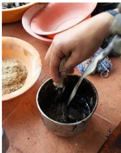
Gráfico N° 29. Premezclado de fibra – cemento asfáltico
