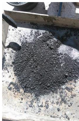
Gráfico N° 16. Mezclado de los agregados.
