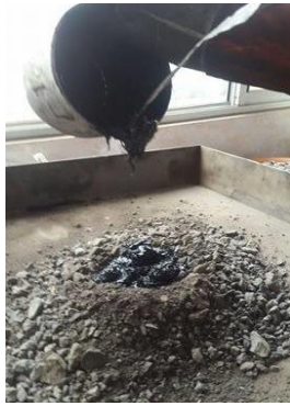
Vertido del asfalto en el agregado
