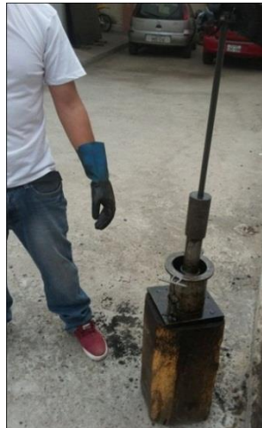
Gráfico N° 17. Moldeado de probetas
