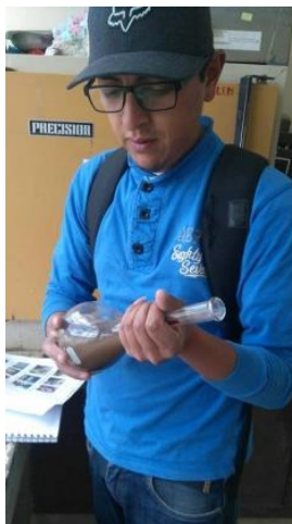
Gráfico N° 11. Expulsión de aire del picnómetro.
