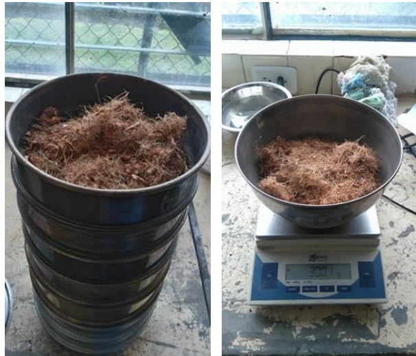
Gráfico N° 28. Tamizado y Pesado de Fibras
