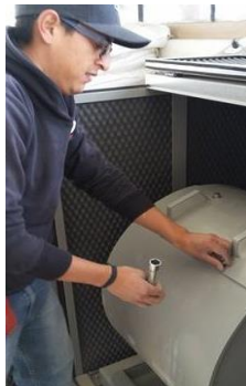
Gráfico N° 13. Desgaste del agregado
