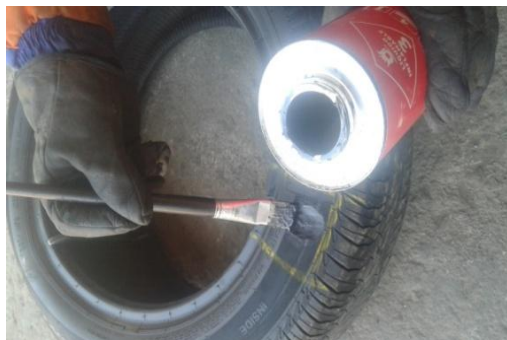
Cementado en el área desbastada
