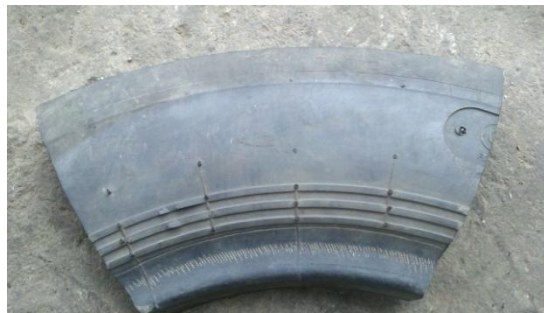
Figura 3.11. Perfil del neumático utilizado como modelo para el molde de fundición.
