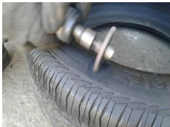
Desbaste de la rotura
