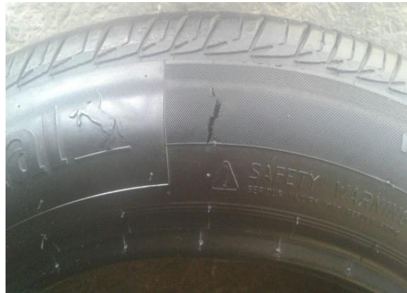
Inspección de la rotura
