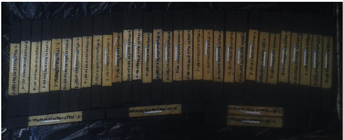
Fig. 69 Probetas para el ensayo de tracción con códigos (Fuente: Autor)
