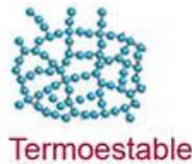
Fig. 5 Cadenas estructurales de matriz termoestable (Fuente: [12])
