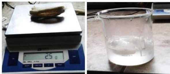
Fig. 26 Determinación de la densidad (Fuente: Autor)
