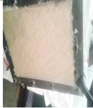
Fig. 56 Desmolde del material híbrido (Fuente: Autor)
