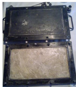
Fig. 16 Moldeo por compresión (Fuente: [6])
