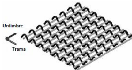
Fig. 14 Diseño esquemático de un tejido (Fuente: [6])
