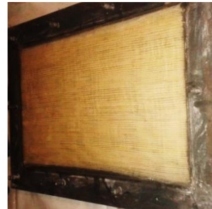
Fig. 54 Vertido de la matriz hasta llenar el molde (Fuente: Autor)
