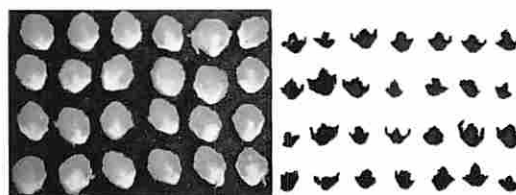
Figura 1. Cortes transversales de granos de arroz pulido a) Imagen capturada del microscopio estereoscópico y b) imágenes de la "panza blanca" binarizada.
