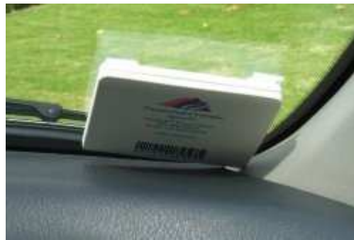
Gráfico 15: Una etiqueta RFID empleada para la recaudación con peaje electrónico
