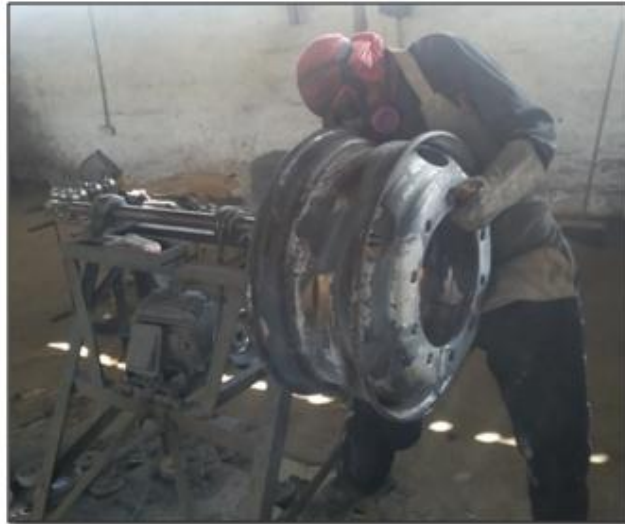
Figura 6.3 Pulido del aro Fuente: (El autor)
