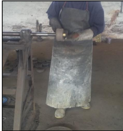
Figura 4.6 Proceso de pulido Fuente: (El autor)
