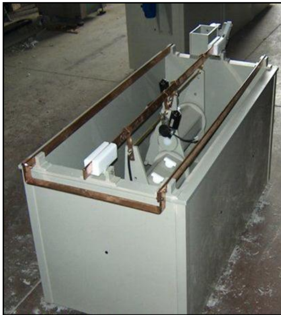
Figura 2.8 Tanque para procesos de niquelado Fuente: (Roymaplast)
