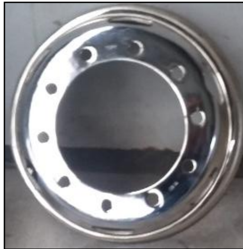
Figura 6.12 Aro de bus recubierto de (Cu+Ni+Cr)
