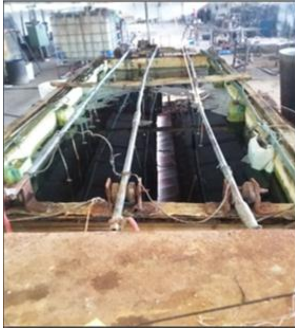
Figura 6.7 Piscina para el proceso de niquelado Fuente: (El autor)
