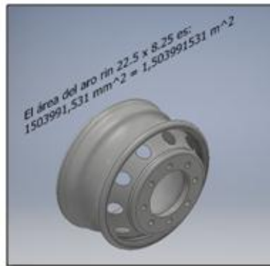
Figura 6.5 Determinación del área lateral del aro
