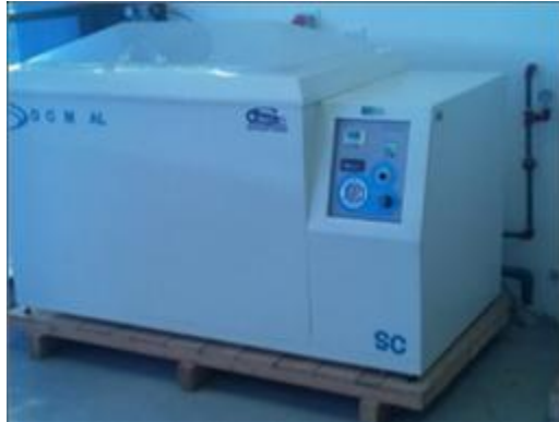
Figura 4.41 Cámara de pruebas de corrosión Fuente: (Centro de Fomento Productivo Metalmeccánico Carrocero)
