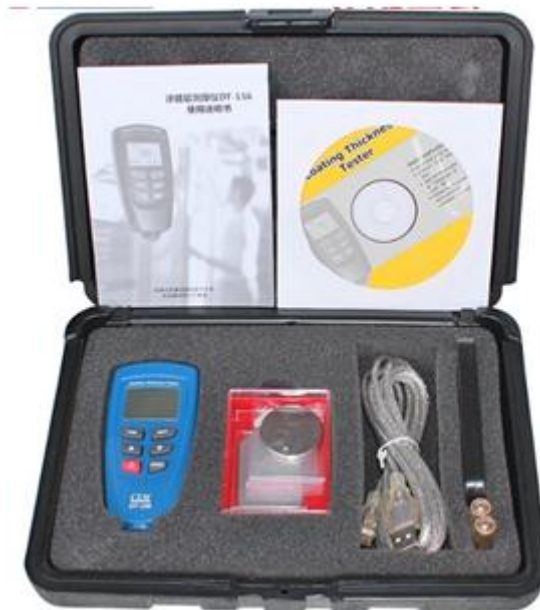
Figura 4.31 Equipo de medición de espesores Fuente: (El autor)
