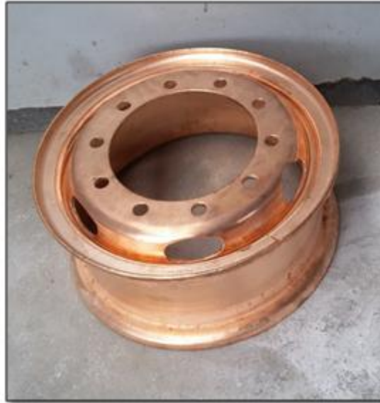
Figura 6.6 Aro cubierto por una capa de cobre Fuente: (El autor)
