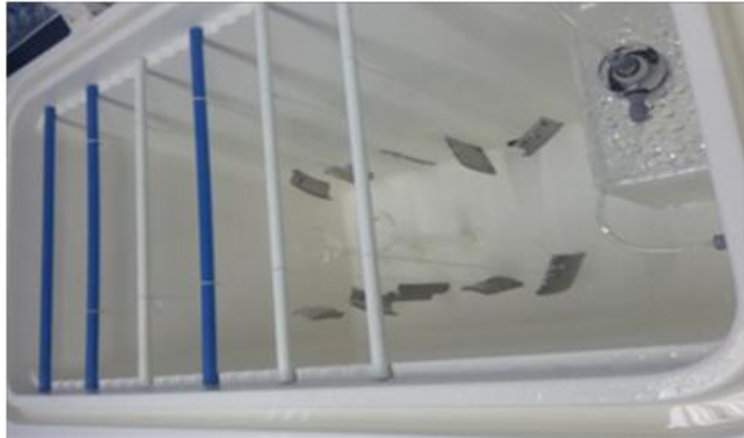
Figura 4.42 Disposición de las probetas en la cámara Fuente: (Centro de Fomento Productivo Metalmeccánico Carrocero)
