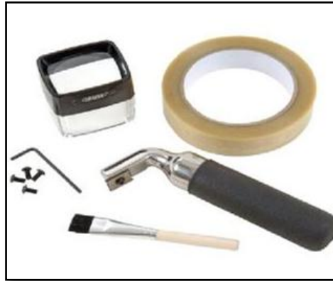
Figura 2.13 Medidor de adherencia por trama cruzada. [11]
