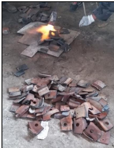
Figura 4.4 Despintado de probetas Fuente: (El autor)
