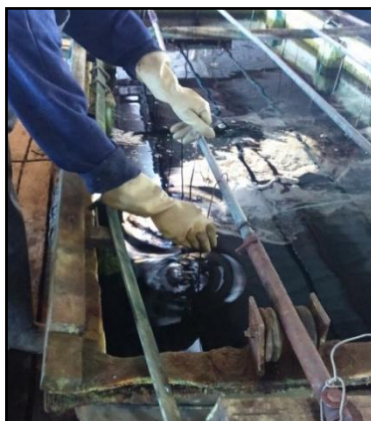
Figura 4.8 Baño de níquel en una piscina de (3.5 X1.25X1.5) m.
