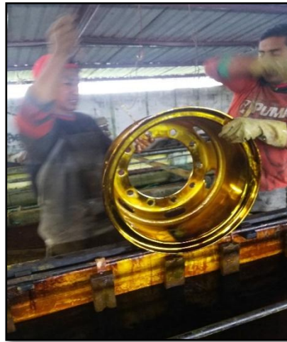
Figura 6.8 Piscina para el proceso de cromado Fuente: (El autor)
