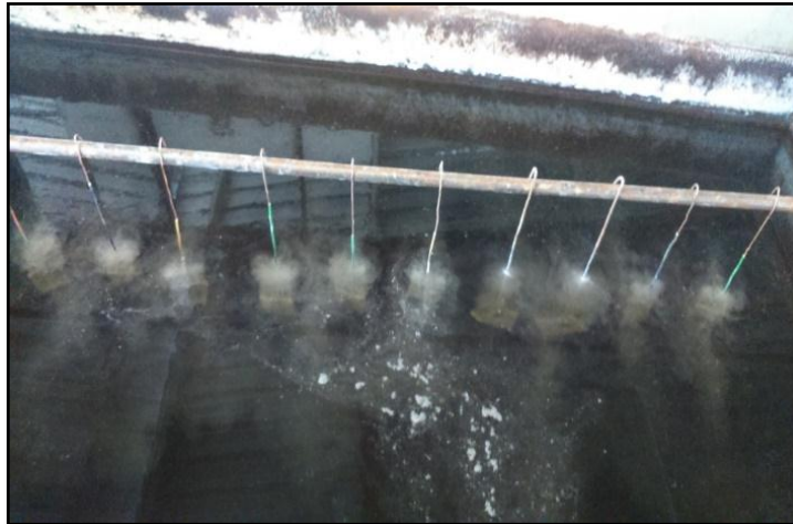
Figura 4.7 Desengrase electrolítico en una piscina de (3 X 1.5 X1.5) m. Fuente: (El autor)
