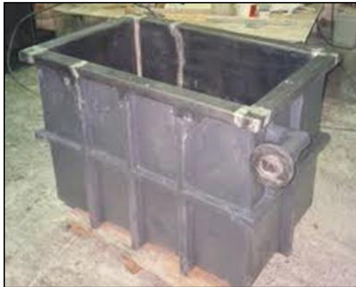
Figura 2.7 Tanque para procesos electrolíticos Fuente. (El autor)
