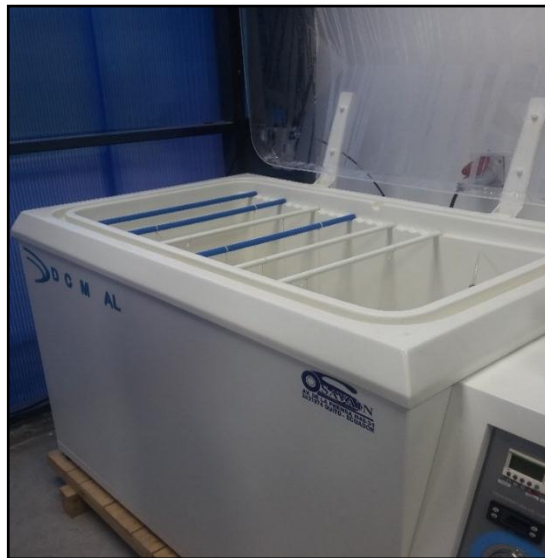
Figura 6.11 Cámara de corrosión acelerada Fuente: ( Centro de Fomento Productivo Metalmecánico Carrocero de Ambato. )
