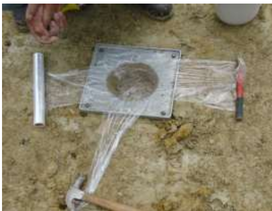
9.- Distribución del plástico en la perforación
