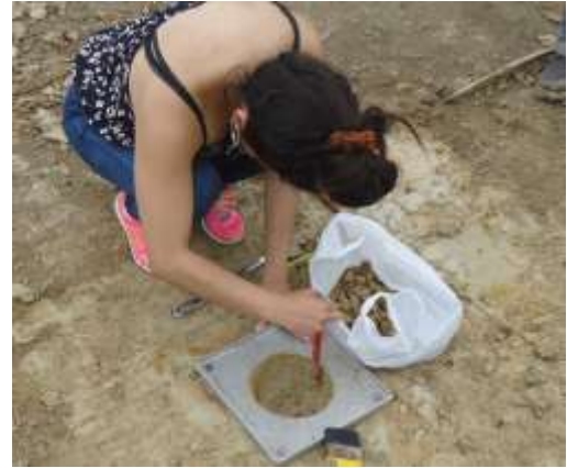
8.- Extracción del suelo natural.
