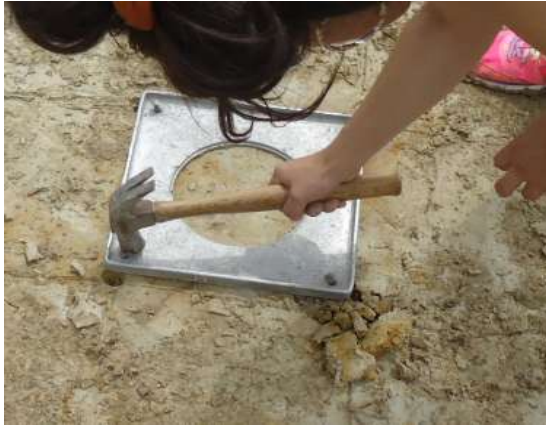
7.- Colocación de la placa con clavos
