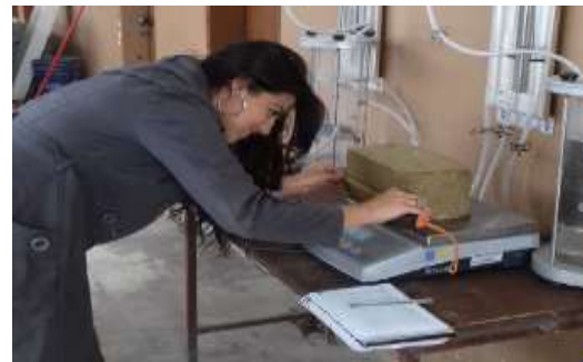
44.- Toma de dimensiones de los bloques.
