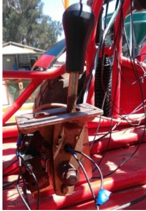
Figura 79 : Montaje de los sensores de finales de carrera en las marchas.
