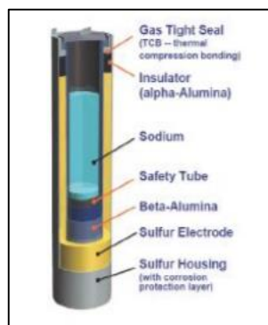
Figura 7 : Esquema batería Sulfuro de Sodio Fuente [21].
