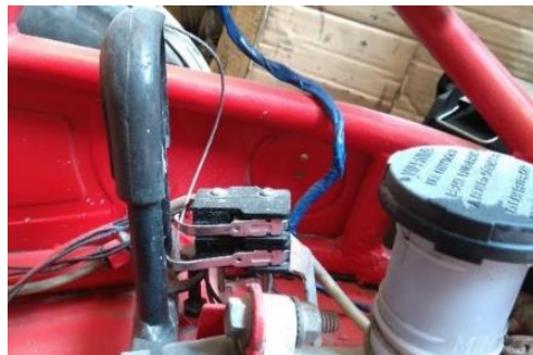
Figura 78 : Montaje de los sensores de finales de carrera en el pedal del freno.
