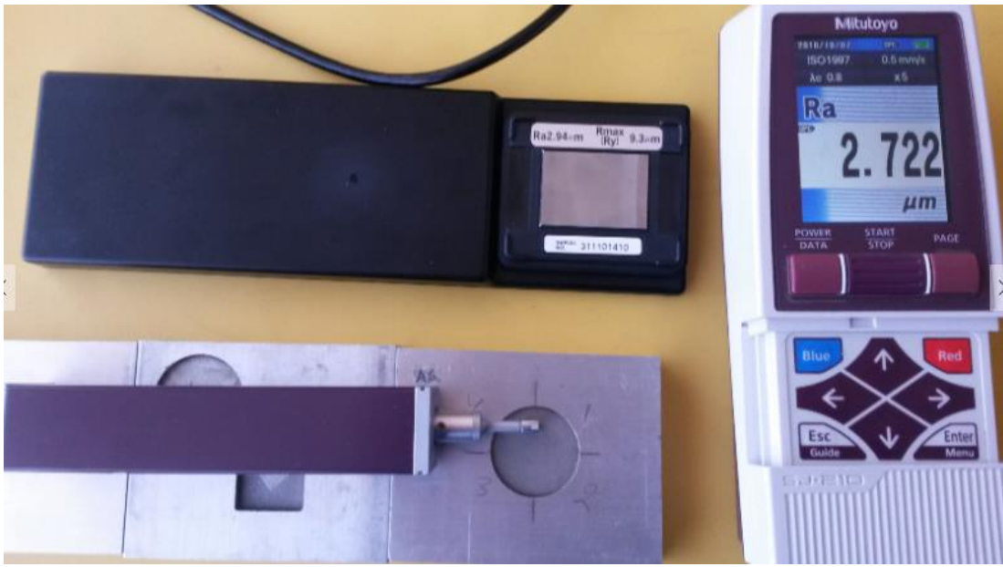
Fig. 3.10: Medición de probetas mediante Rugosímetro Mitutoyo SJ210 Fuente: (El autor)
