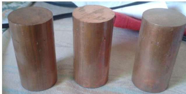
Fig. 3.9: Electrodo de cobre Fuente: (El autor)
