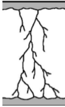
Fig. 2.1: Descarga ramificada en un medio gaseoso [7].
