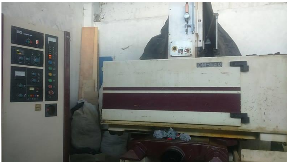
Fig. 3.7: Máquina electroerosionadora Chevalier DM-540. Taller de ingeniería del acero y matriceria.
