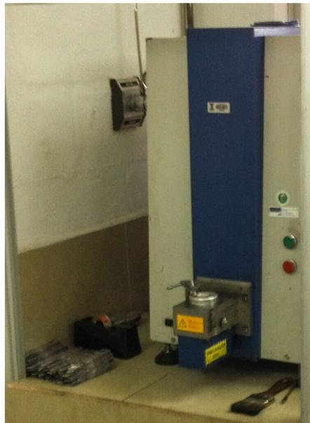
**Figura 2.7** Espectrómetro de Emisión Óptica perteneciente a CEDAL S.A.
