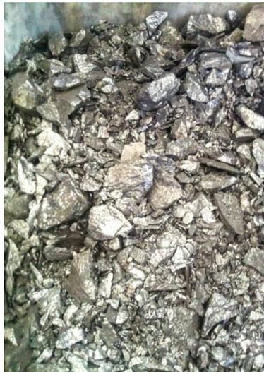
**Figura 2.3** Silicio en trozos para uso en aleación AA6063.
