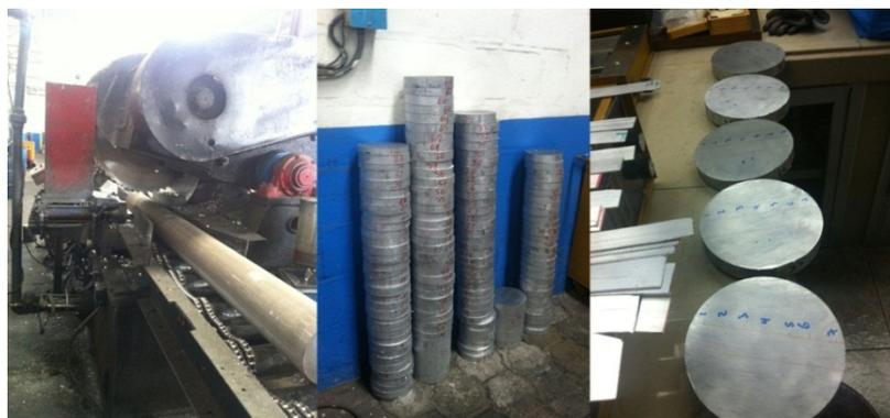
**Figura 4.3** Corte de muestras proveniente de billet.
