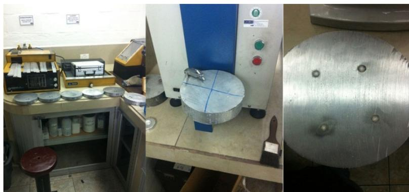
**Figura 4.6** Espectrometría de cortes proveniente de billets.
