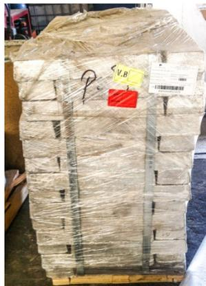
**Figura 2.2** Magnesio en forma de lingotes para uso en aleación AA6063.
