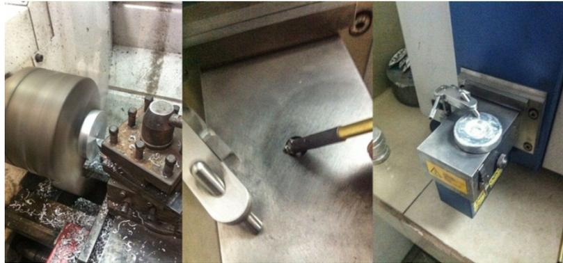
**Figura 4.5** Procedimiento preparación muestra y análisis espectrométrico.
