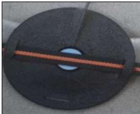
Figura 5. Acelerómetro para cuerpo entero AC033.
