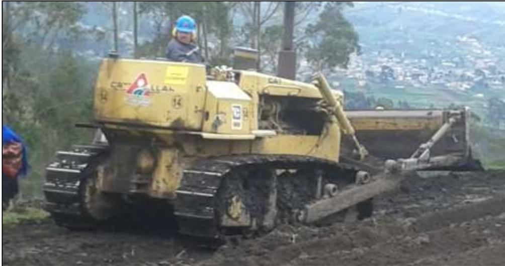
Figura 8. Orugas de un tractor.
