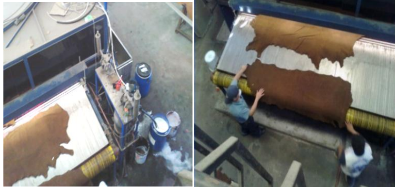
Figura No. 4.20: Proceso de colocación de base Fuente: Curtiduría Hidalgo
