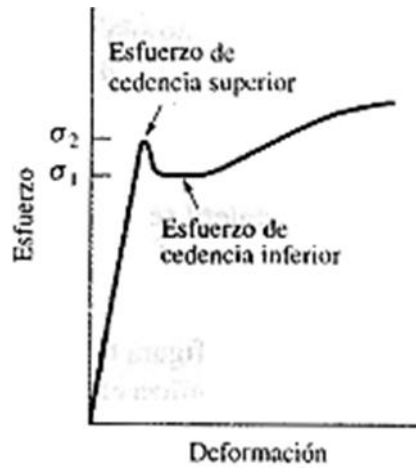
Figura 19. Esfuerzo de cedencia superior e inferior de un acero de bajo carbono Fuente: (Askeland D, 2002)
