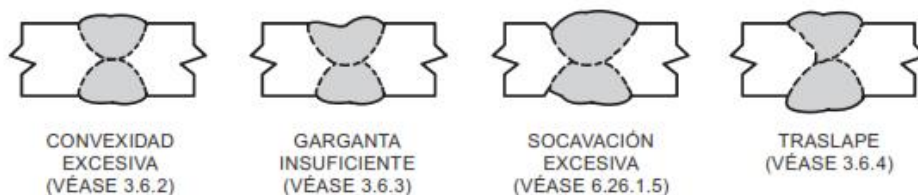
(E) PERFILES INACEPTABLES DE SOLDADURAS DE RANURA EN JUNTAS A TOPE
