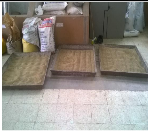
Muestras de Suelo secada y triturada que pasa en tamiz #4
