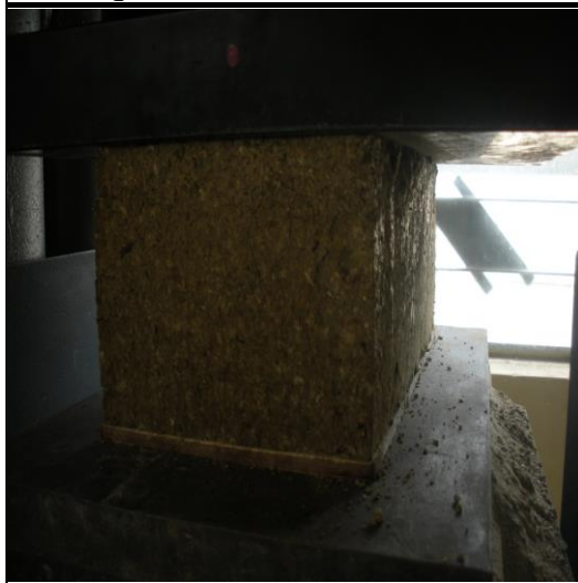
Ensayo a compresión del bloque estabilizado con 2,5% de Cloruro de Sodio
