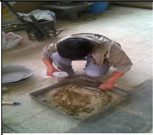
Preparación de la muestra para realizar los bloques
