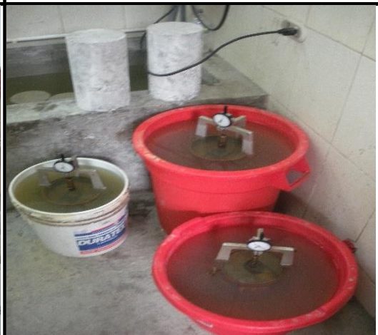
Esponjamiento del ensayo del CBR
