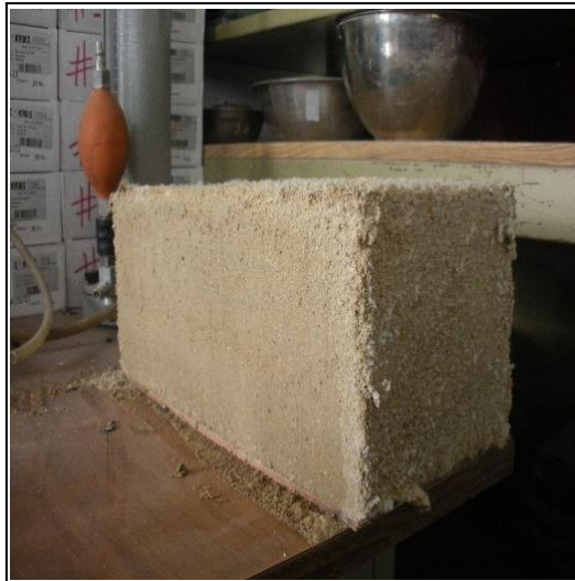
Exceso del Cloruro de Sodio en el bloque con 12,5% a los 21 días
