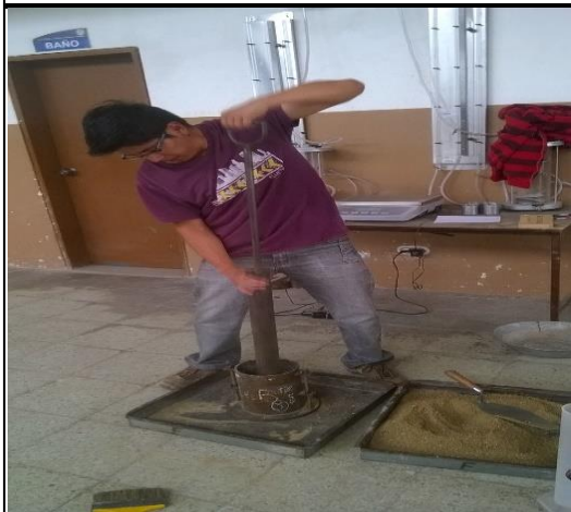
Compactación den ensayo Próctor Modificado método D
