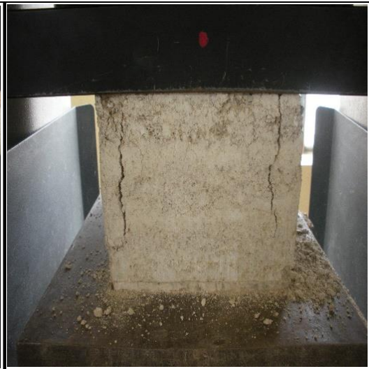
Ensayo a compresión del bloque estabilizado con 12,5% de Cal
