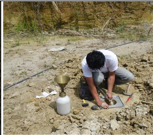
Ensayo de Cono y Arena de Ottawa
