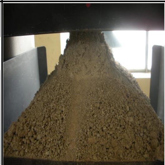
Ensayo a compresión del bloque estabilizado con 12,5% de Cloruro de Sodio
