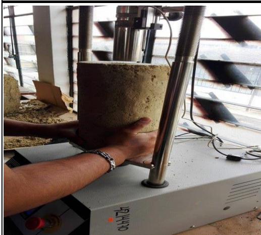
Ensayo a compresión de la muestra inalterada
