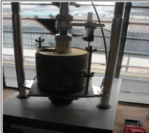
Ensayo de CBR para suelo arcilloso
