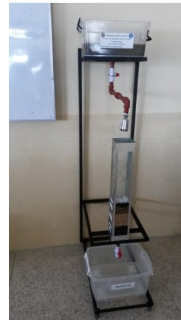
Fotografía N° 18. Filtro a nivel de laboratorio
