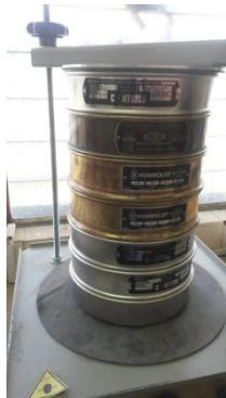
Fotografía N° 5. Ensayo de granulometría
