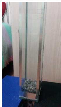
Fotografía N° 7. Colocación del primer material filtrante (Grava)
