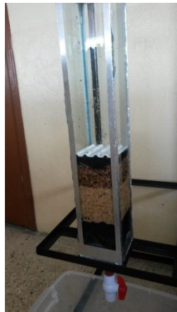
Fotografía N° 11. Colocación del quinto material filtrante (CACF)
