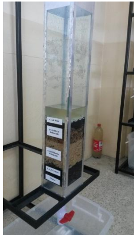
Fotografía N° 15. Filtro artesanal con materiales no convencionales
