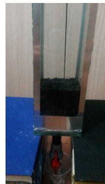
Fotografía N° 8. Colocación del segundo material filtrante (CACG)
