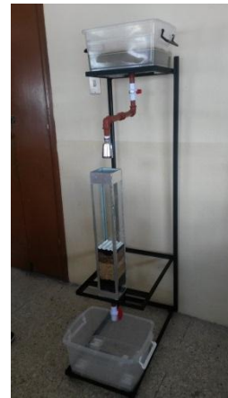
Fotografía N° 12. Filtro artesanal completo para funcionamiento
