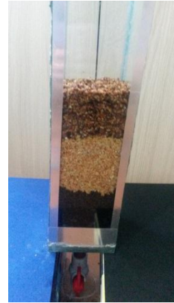
Fotografía N° 10. Colocación del cuarto material filtrante (fréjol rojo)
