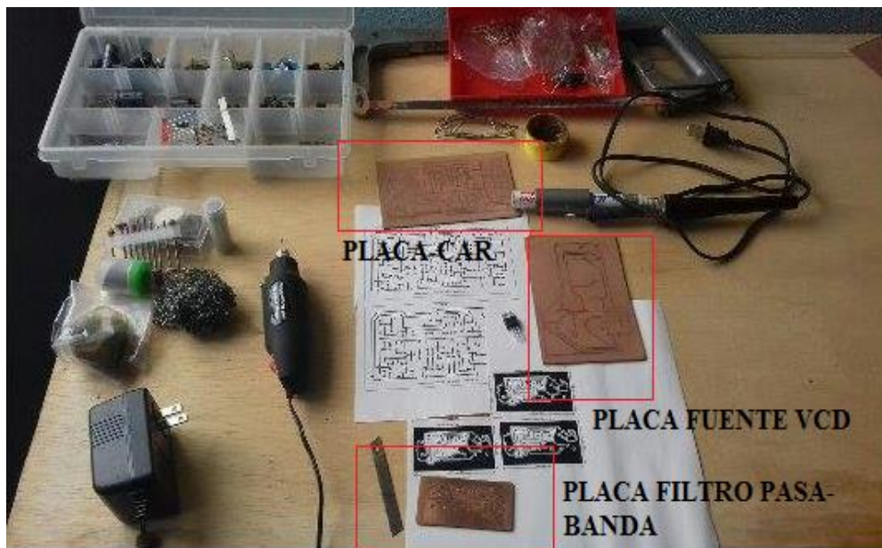
Fig. 4.41 Aspecto físico de las placas impresas de los circuitos que forman parte del prototipo
