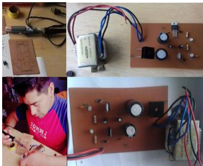
Fig. 4. 42 Circuito terminado etapa de alimentación
