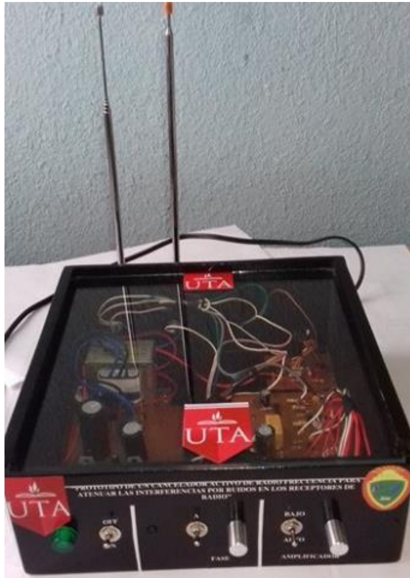
Fig. 4. 46 Cancelador activo de radio frecuencia para atenuar las interferencias por ruidos en los receptores de radio
