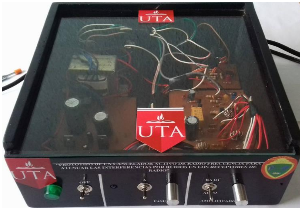
Fig. 4. 45 Montaje del prototipo de cancelación activo de radio frecuencia
