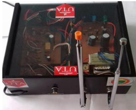
Fig. 12 Conexión de la antena de RF y antena de ruido en el CAR
