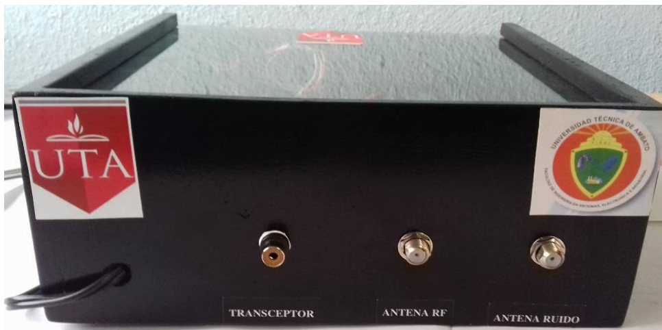
Fig. 4. 48 Cancelador activo de radio frecuencia vista posterior
