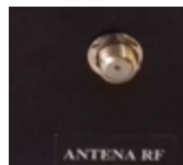
Fig. 5 Entrada de la antena de RF.
