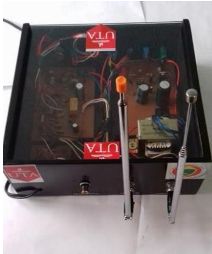
Fig. 4. 51 Conexión de la antena de RF y antena de ruido en el CAR
