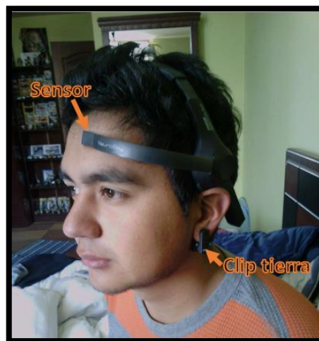
Figura 4.43 Colocación MindWave Fuente: Investigadora
