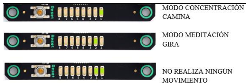
Figura 4.37 Leds que muestran las salidas y el modo de funcionamiento Fuente: Investigadora basado en IDE Mojo
