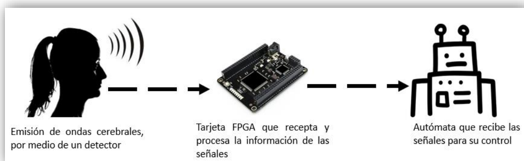
Figura 4.1 Esquema del sistema para el control del autómatas Fuente: Investigadora
