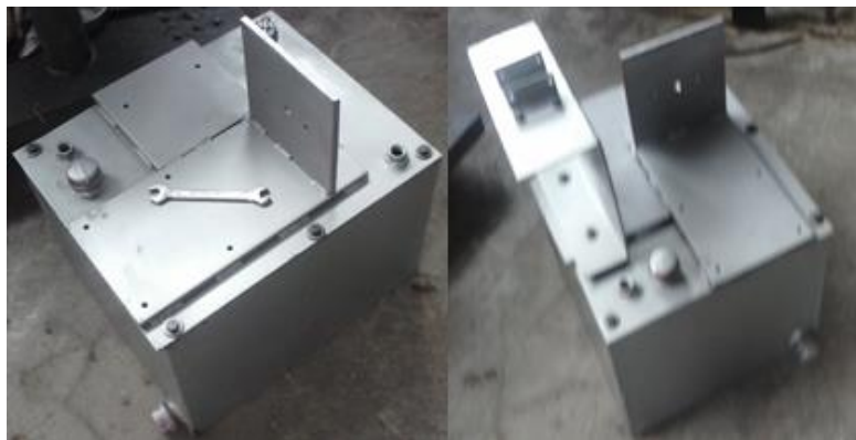
Figura 49. Depósito hidráulico terminado
