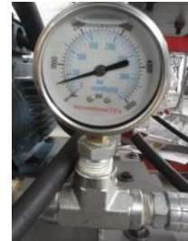
Figura 42. Manómetro 0-5000 Psi/0-35 MPa
