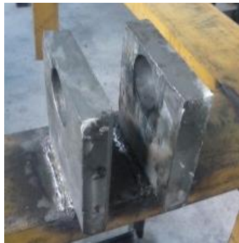
Figura 57. Soporte para actuador soldado a la estructura
