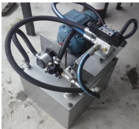
Figura 50. Central hidráulica terminada
