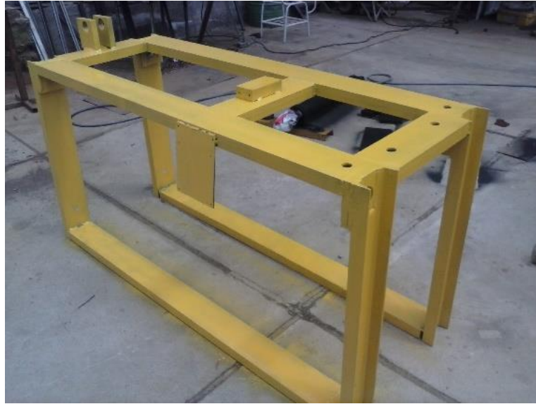
Figura 109. Ensamble final de la estructura
