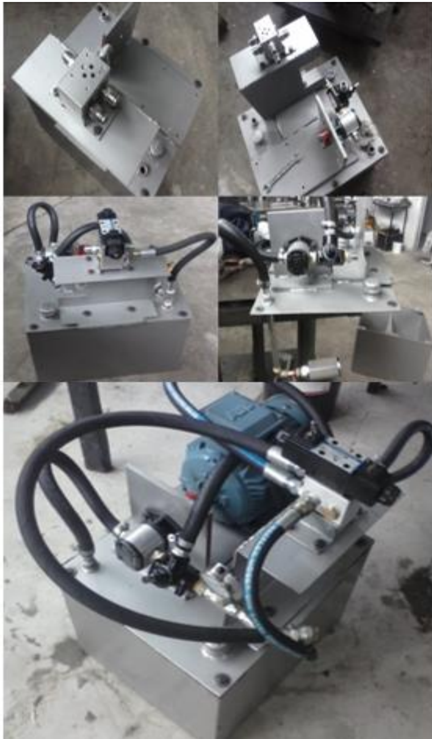
g. Ensamble de la central hidráulica
