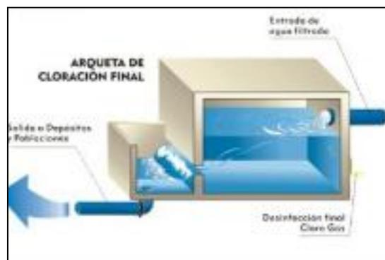
Figura 5. Esquema Tratamiento Terciario Cloración
