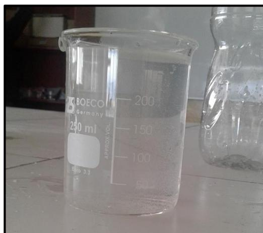
**Ilustración 3.** Agua filtrada por bagazo
