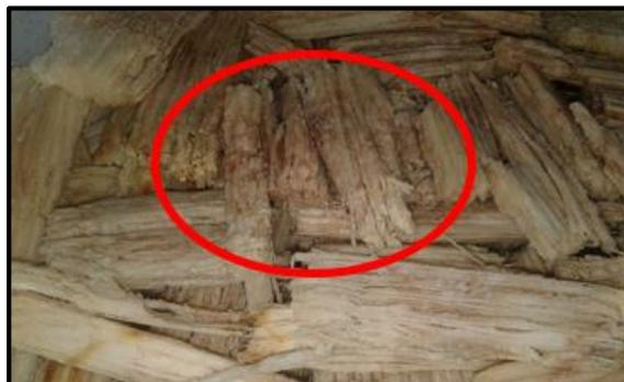
**Ilustración 10.** Bagazo después de filtrado
