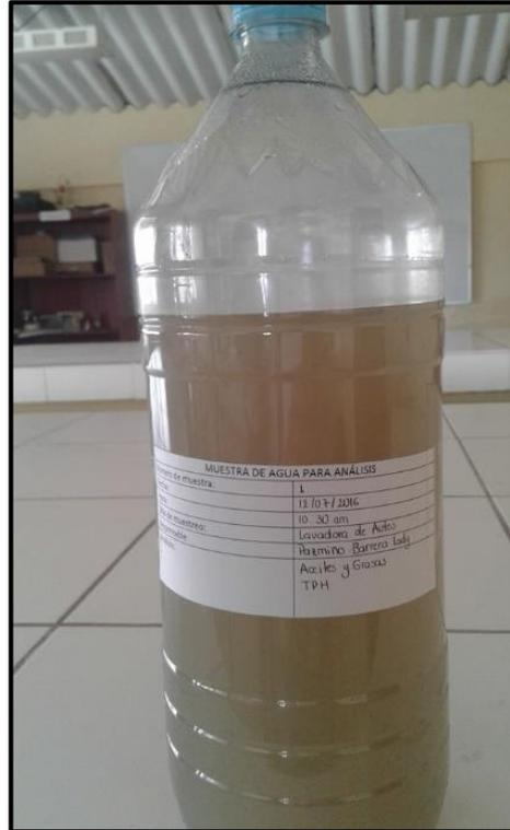
**Ilustración 40.** Toma de muestra antes de filtrar
