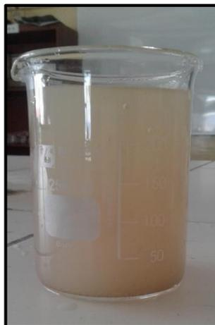
**Ilustración 7.** Agua filtrada por arena
