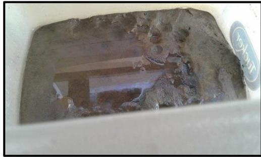
**Ilustración 44.** Película de aceite formada en la superficie de la arena
