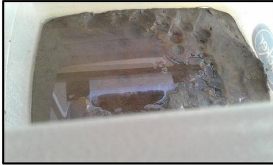
**Ilustración 43.** Película de aceite formada en la superficie de la arena
