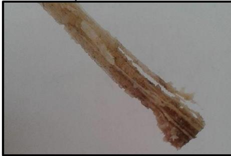
**Ilustración 45.** Partículas retenidas en el bagazo de caña de azúcar
