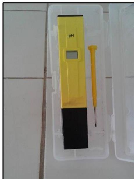
**Ilustración 26** Medidor de pH
