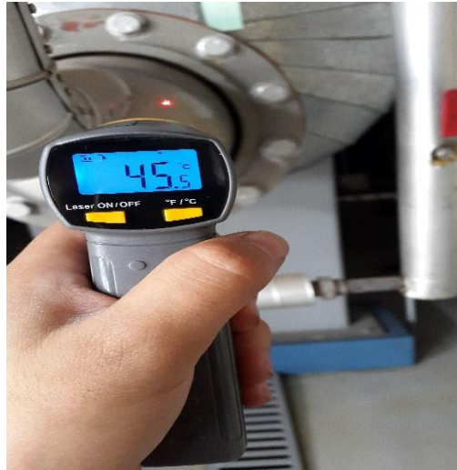
Figura 3-2; Temperatura de la parte frontal del intercambiador de calor mediante el termómetro infrarrojo.
