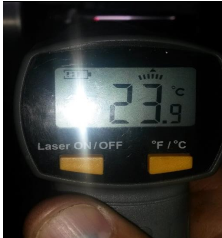
FIGURA 3. 12 Medida de temperatura final en la superficie con pirómetro láser sin lubricación ya que no se cuenta con una cámara termo gráfica para medir durante el proceso..
