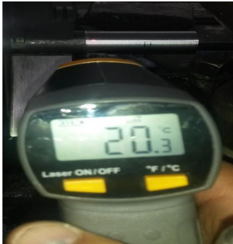
FIGURA 3. 19 Medida de temperatura final en la superficie con pirómetro láser en el Sistema de Mínima Lubricación ya que no se cuenta con una cámara termo gráfica para medir durante el proceso.
