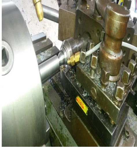
FIGURA 3. 5 Centrado y Cilindrado de las probetas
