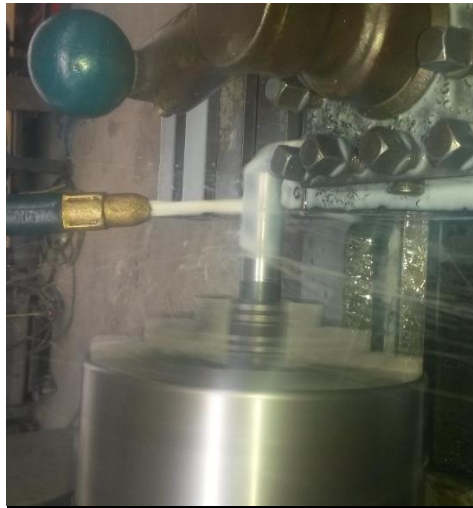
FIGURA 3. 14 Mecanizado con taladrina
