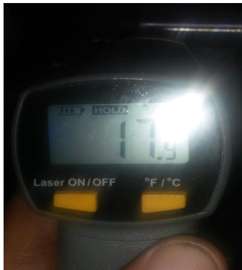
FIGURA 3. 15 Medida de temperatura final en la superficie con pirómetro láser en el sistema de inundación ,ya que no se cuenta con una cámara termo gráfica para medir durante el proceso.
