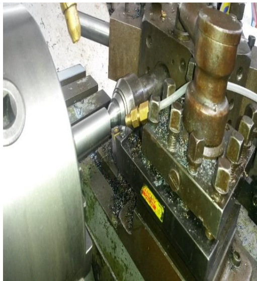
FIGURA 3. 18 Mecanizado de la probeta con el Sistema de Mínima Lubricación.
