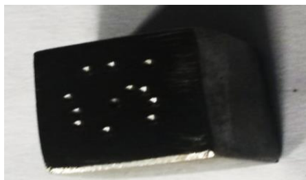
FIGURA 3. 2 Probeta de ensayo de Dureza
