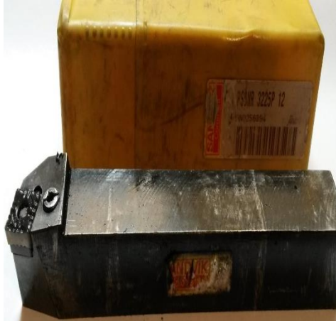
FIGURA 3. 10 Porta insertos marca Sandvik
