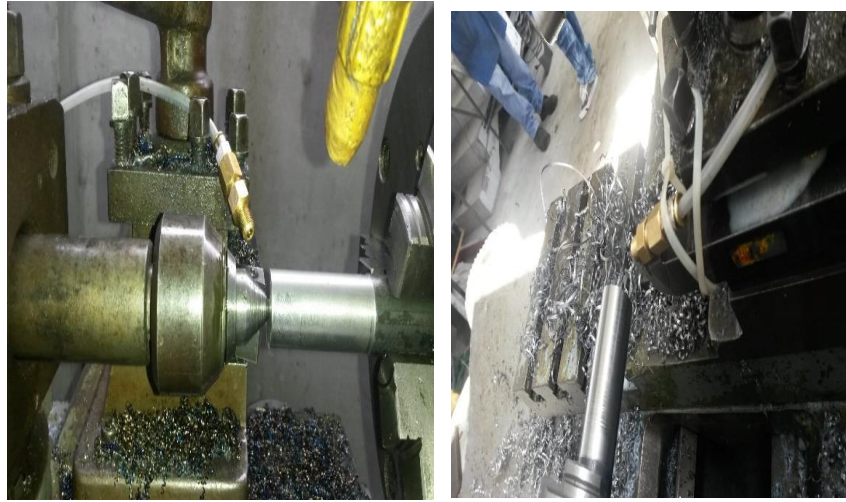
FIGURA 3. 17 Aseguramiento de la válvula aspersor de la mezcla aire – aceite vegetal
