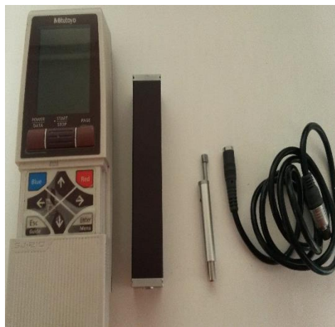
FIGURA 3. 22 Partes del Rugosímetro.
