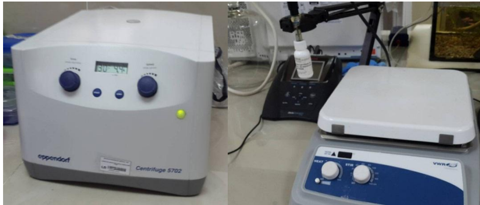
Figura 3. Centrífuga y pH-metro
