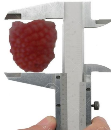
Figura 19. Medición del calibre de la fruta con un pie de rey
