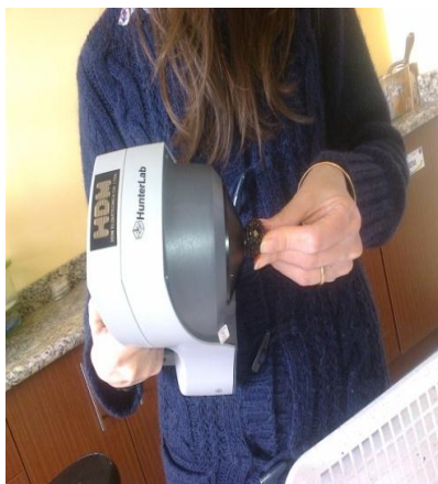
Figura 22. Determinación de color mediante un colorímetro
