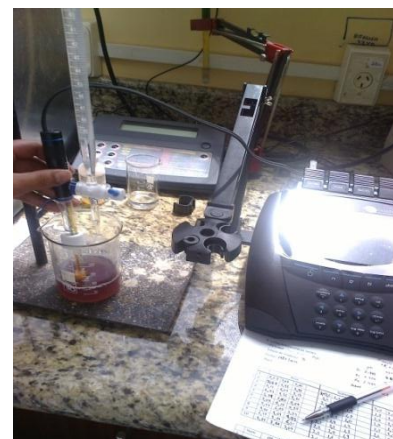
Figura 23. Determinación de pH mediante potenciometría
