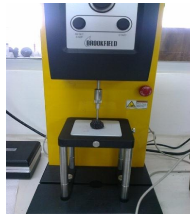
Figura 21. Determinación de firmeza mediante un texturómetro
