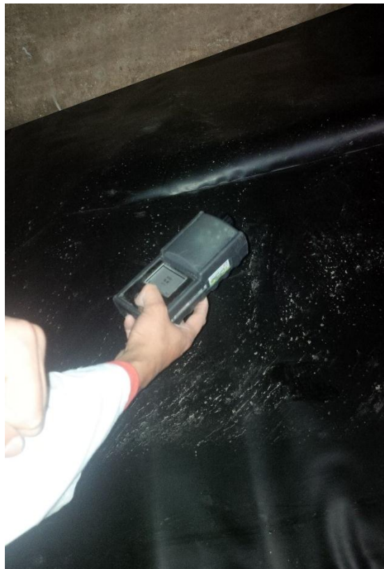
Fotografía 8 Evaluación de gases después del control utilizando el equipo Ibrid MX6
