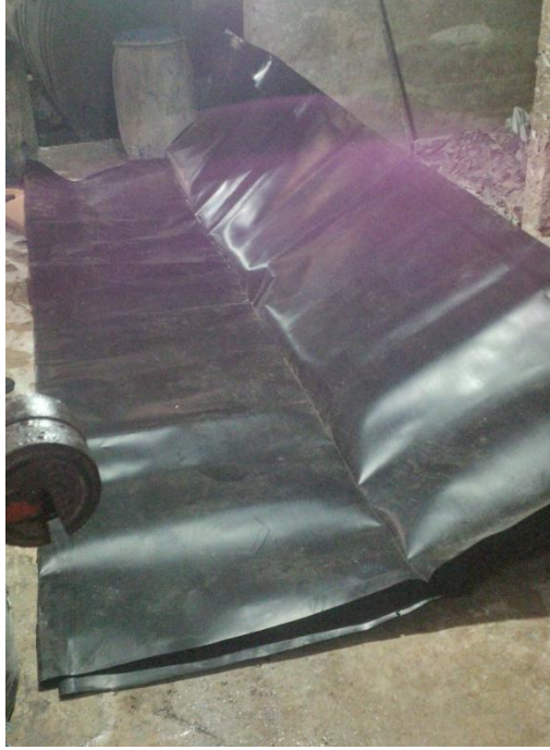
Fotografía 5 Geomembrana HDPE a instalar.
