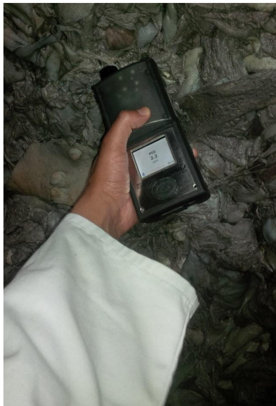
Fotografía 4 Evaluación de gases antes del control utilizando el equipo Ibrid MX6
