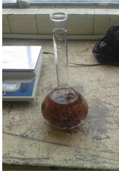
DETERMINACIÓN DE LA DENSIDAD REAL DEL CEMENTO
