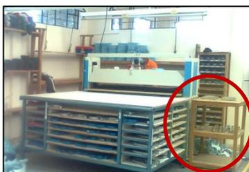
**Fig. 143. Troqueles ubicados junto al área de corte**
