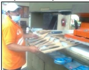
**Fig. 64. Áreas de corte (uso de troqueles) - necesidad de guantes de protección**
