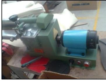
Fig. 20. Máquina engomadora
