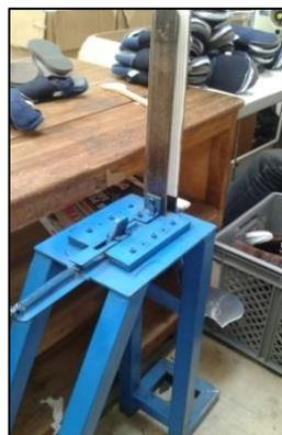
**Fig. 53. Herramienta para introducir las plantillas de relleno en la pantufla**
