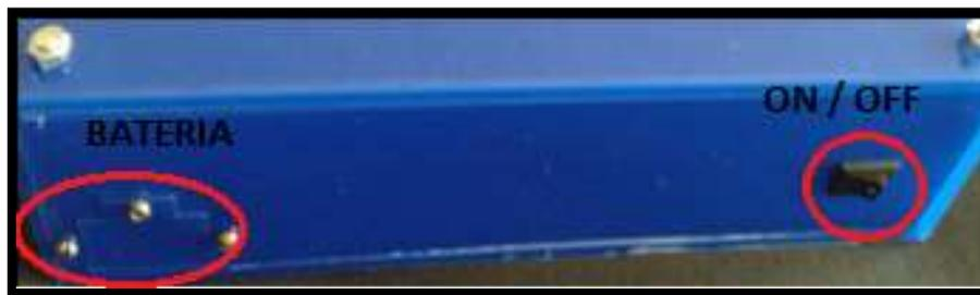
**Figura 4.36:** Botón de Encendido y colocación de Batería
