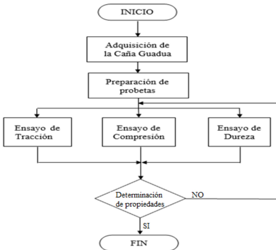
Diagrama 4.1 Proceso de obtención de resultados del comportamiento mecánico de la Caña Guadua (Fuente: Autor)
