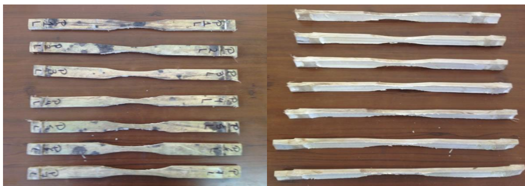
Figura 4.2 Probetas lisas para ser sometidas a ensayo de tracción (Fuente: Autor)
