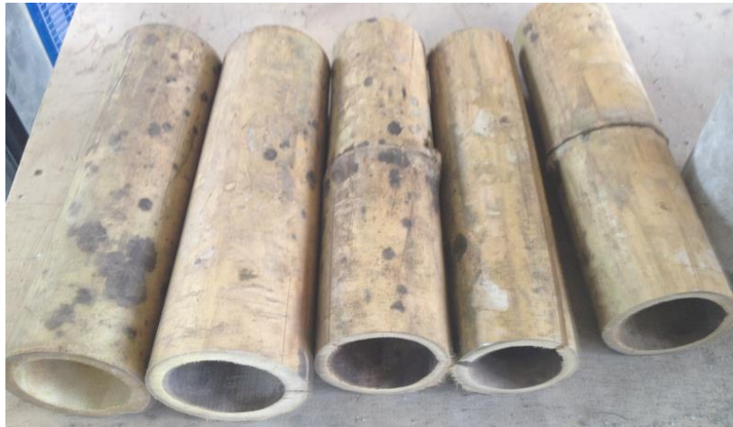
Figura 4.7 Probetas lisas para ser sometidas a ensayo de compresión. (Fuente: Autor)
