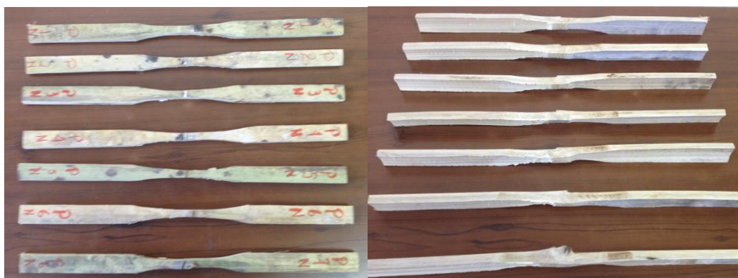
Figura 4.3 Probetas con nudo intermedio para ser sometidas a ensayo de tracción (Fuente: Autor)
