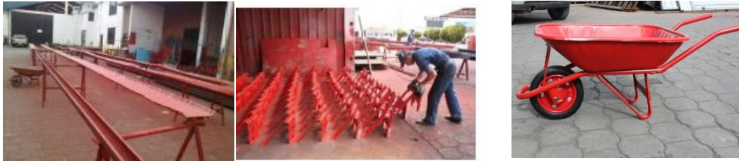
Gráfico No. 30 Pintura de Partes de Carretillas
