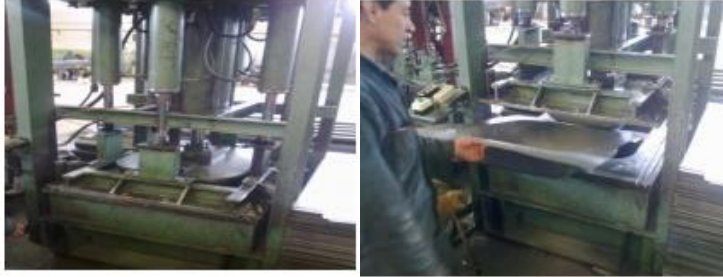
Gráfico No. 21 Prensado Balde de Carretilla
