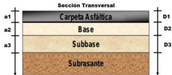
Gráfico 30. Estructura esquemática para pavimento flexible
