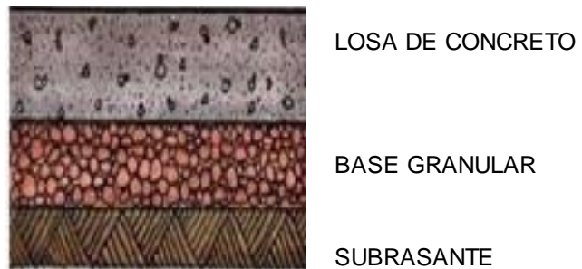
Grafico 16. Estructura de un pavimento rígido
