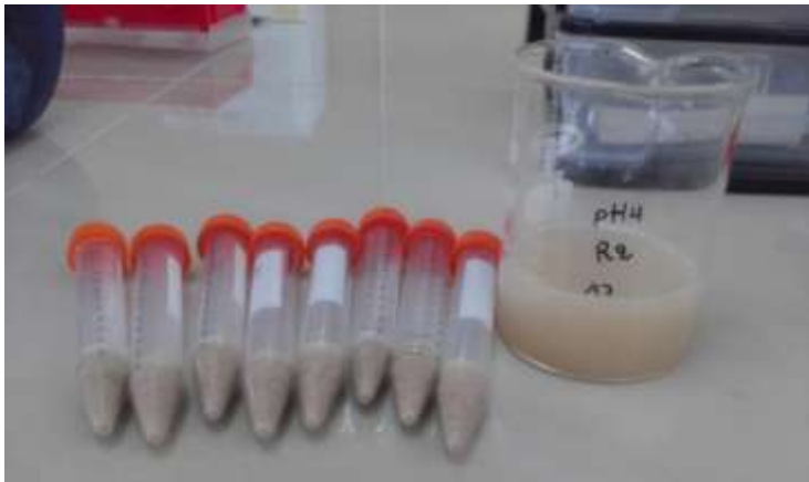
SEPARACIÓN DE SOBRENADANTE Y AJUSTE DE pH DE PRECIPITACIÓN
