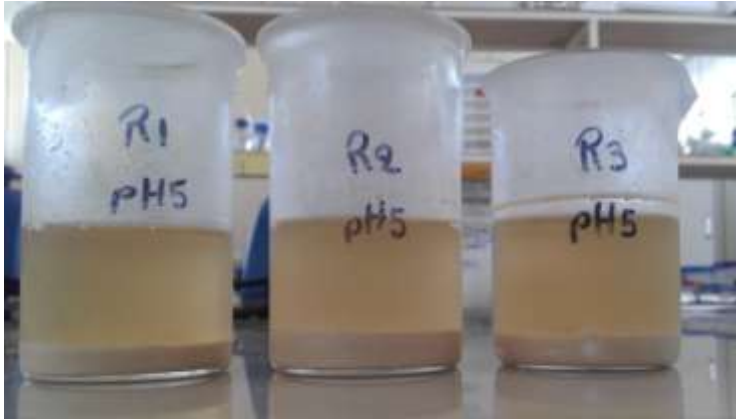
PRECIPITACIÓN DE LA PROTEÍNA EN REFRIGERACIÓN Y SEPARACIÓN DEL SOBRENADANTE
