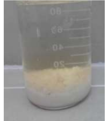
PRECIPITACIÓN DE LA PROTEÍNA EN REFRIGERACIÓN Y SEPARACIÓN DEL SOBRENADANTE
