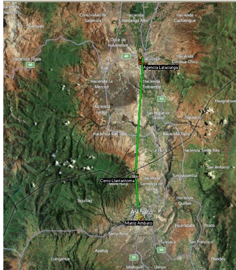
Figura N° 6.21. Diagrama del enlace completo realizado con Radio Mobile
