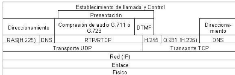
Figura N° 6.7. Stack de protocolos H.323
