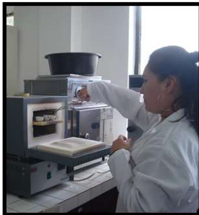
Colocación de materia seca de los forrajes en la mufla y desecador (enfriamiento) para la obtención de ceniza.
