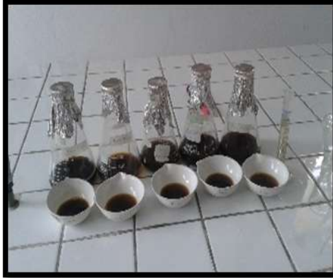
Materia cruda filtrada colocada en crisoles a baño maria.
