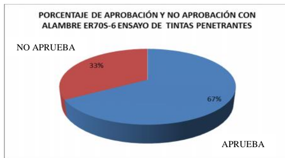
Figura 4.25: Porcentaje de aprobación y no aprobación con alambre ER70S-6 (tintas penetrantes coloreadas)
