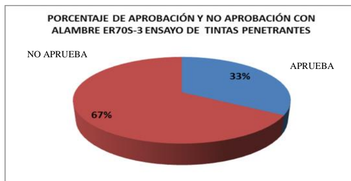
Figura 4.24: Porcentaje de aprobación y no aprobación con alambre ER70S-3 (tintas penetrantes coloreadas)
