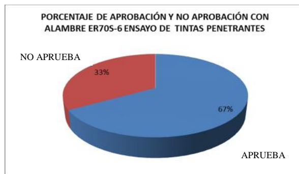
Figura 4.19: Porcentaje de aprobación y no aprobación con alambre ER70S-6 (tintas penetrantes fluorescentes)
