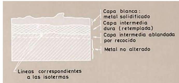
Figura 2. 24 Esquema del aspecto de la superficie de un acero electro erosionado
