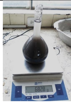
Fotografía 24.- Ensayo Densidad Real de CCA y CBC
