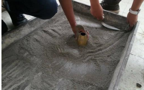
Fotografía 8.- Ensayo Densidad Estado SSS
