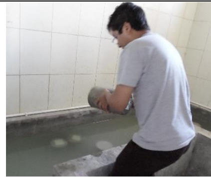
Fotografía 26.- Curado de Cilindros
