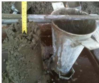
Fotografía 10.- Ensayo Cono de Abrams
