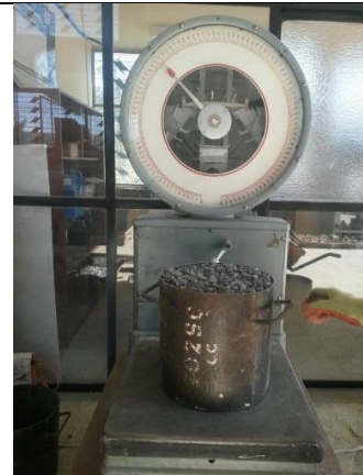
Fotografía 5.- Ensayo Densidad Aparente (peso)
