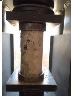
Fotografía 27.- Ensayo Cilindros 7, 14 y 28 días de edad de curado
