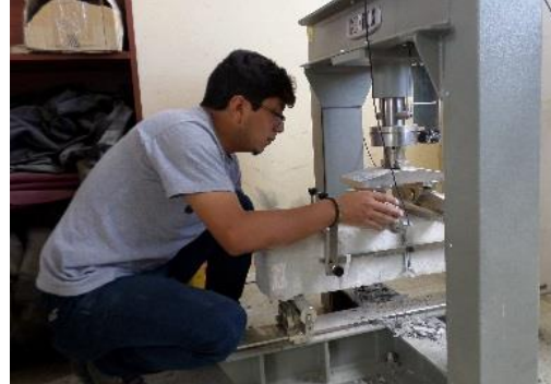
Fotografía 36.- Colocación de la Probeta en la Máquina
