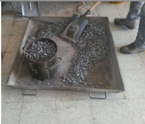
Fotografía 4.- Ensayo Densidad Aparente (mezcla)
