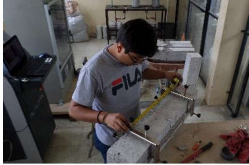
Fotografía 35.- Colocación de Instrumentos para el Ensayo
