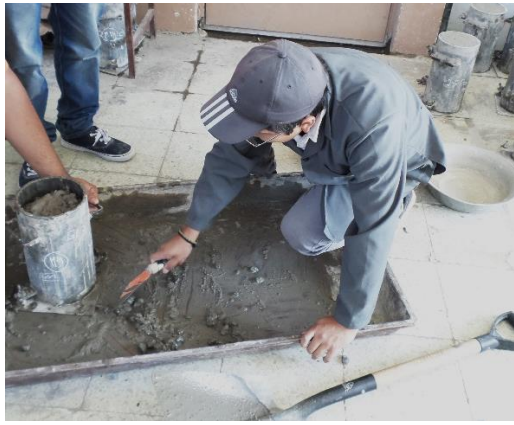
Fotografía 12.- Preparación de Probetas de Hormigón
