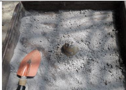
Fotografía 22.- Ensayo Densidad Estado SSS de CCA y CBC
