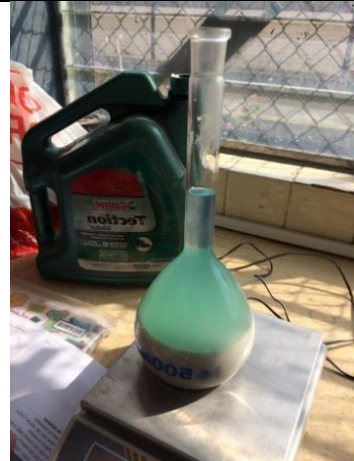
Fotografía 9.- Ensayo Densidad Real del Cemento
