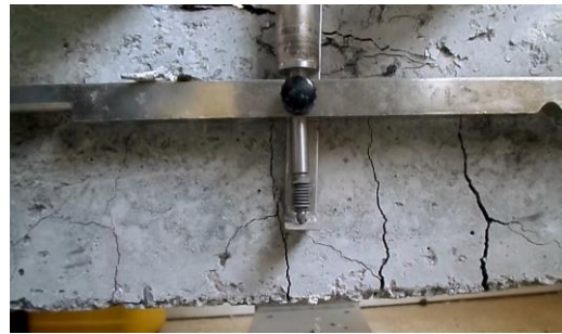
Fotografía 38.- Fisuras en el ensayo
