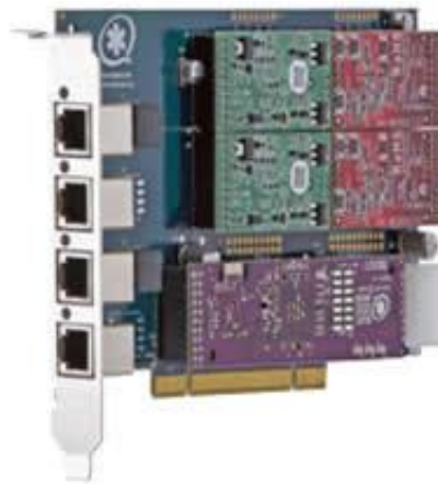
Figura 6.6.7 Tarjeta PCI de 2 puertos FXO y 2 puertos FXS
