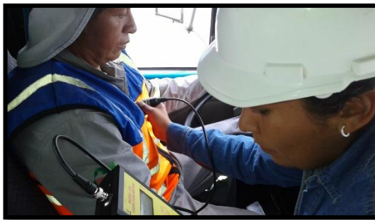
Fotografía 52. Medición Vibración cuerpo entero eje x (Operario 6).
