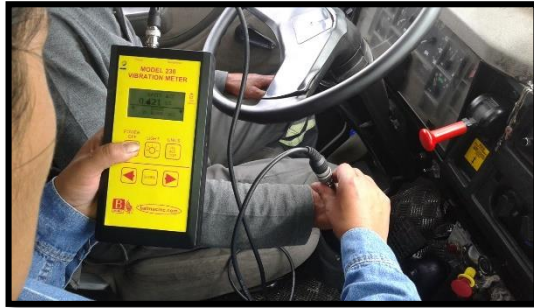
Fotografía 73. Medición Vibración mano brazo (derecho) eje x (Operario 9).
