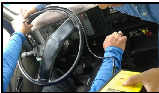
Fotografía 104. Medición Vibración mano brazo (izquierdo) eje y (Operario 12).
