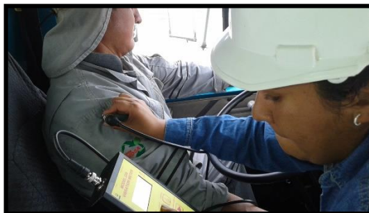
Fotografía 71. Medición Vibración cuerpo entero eje y (Operario 8).
