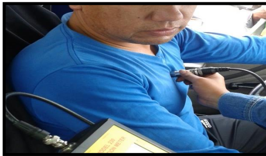
Fotografía 106. Medición Vibración cuerpo entero eje x (Operario 12).
