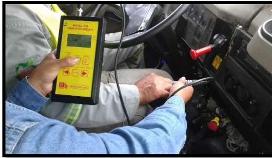
Fotografía 93. Medición Vibración mano brazo (derecho) eje z (Operario 11).
