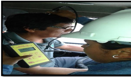
Fotografía 9. Medición Vibración cuerpo entero eje z (Operario 1).
