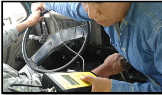
Fotografía 69. Medición Vibración mano brazo (izquierdo) eje z (Operario 8).
