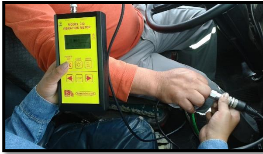
Fotografía 39. Medición Vibración mano brazo (derecho) eje z (Operario 5).
