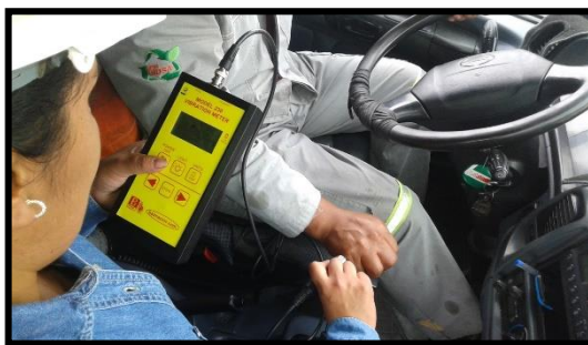
Fotografía 11. Medición Vibración mano brazo (derecho) eje y (Operario 2).
