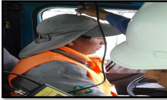
Fotografía 63. Medición Vibración cuerpo entero eje z (Operario 7).
