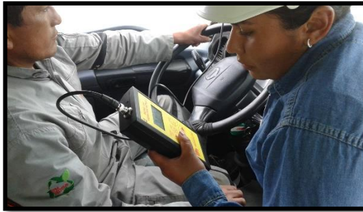
Fotografía 24. Medición Vibración mano brazo (izquierdo) eje z (Operario 3).
