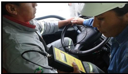
Fotografía 14. Medición Vibración mano brazo (izquierdo) eje y (Operario 2).
