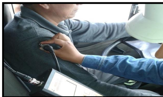
Fotografía 80. Medición Vibración cuerpo entero eje y (Operario 9).
