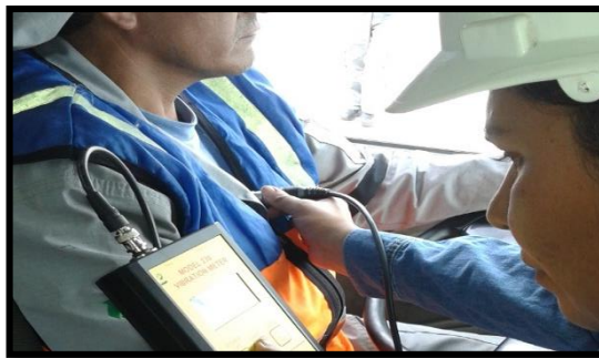
Fotografía 88. Medición Vibración cuerpo entero eje x (Operario 10).
