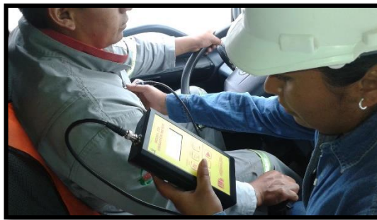
Fotografía 16. Medición Vibración cuerpo entero eje x (Operario 2).
