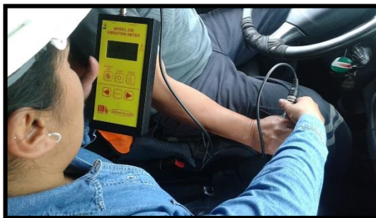
Fotografía 2. Medición Vibración mano brazo (derecho) eje y (Operario 1).
