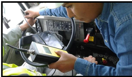
Fotografía 94. Medición Vibración mano brazo (izquierdo) eje x (Operario 11).
