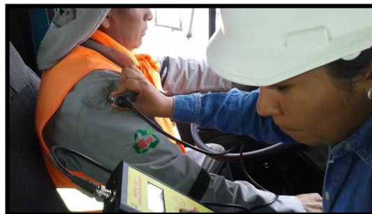
Fotografía 62. Medición Vibración cuerpo entero eje y (Operario 7).
