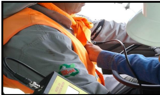
Fotografía 61. Medición Vibración cuerpo entero eje x (Operario 7).
