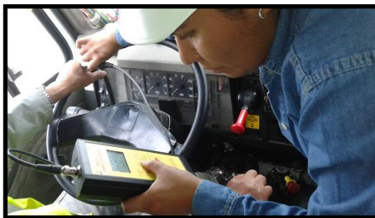
Fotografía 95. Medición Vibración mano brazo (izquierdo) eje y (Operario 11).
