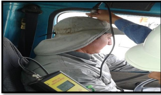
Fotografía 72. Medición Vibración cuerpo entero eje z (Operario 8).
