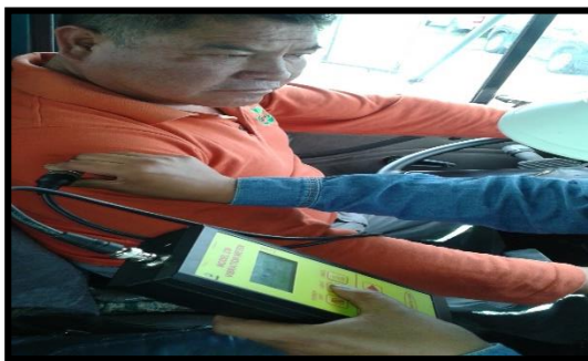
Fotografía 44. Medición Vibración cuerpo entero eje y (Operario 5).
