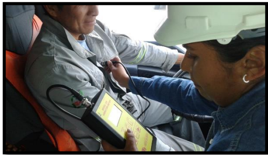
Fotografía 34. Medición Vibración cuerpo entero eje x (Operario 4).
