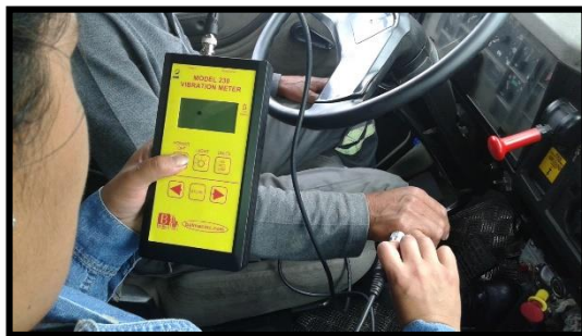
Fotografía 74. Medición Vibración mano brazo (derecho) eje y (Operario 9).
