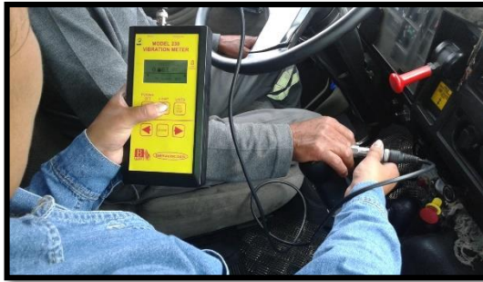
Fotografía 75. Medición Vibración mano brazo (derecho) eje z (Operario 9).
