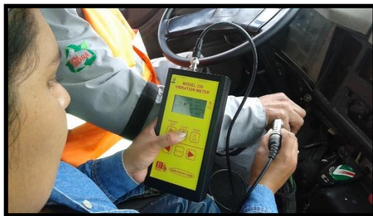
Fotografía 56. Medición Vibración mano brazo (derecho) eje y (Operario 7).
