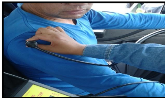
Fotografía 107. Medición Vibración cuerpo entero eje y (Operario 12).
