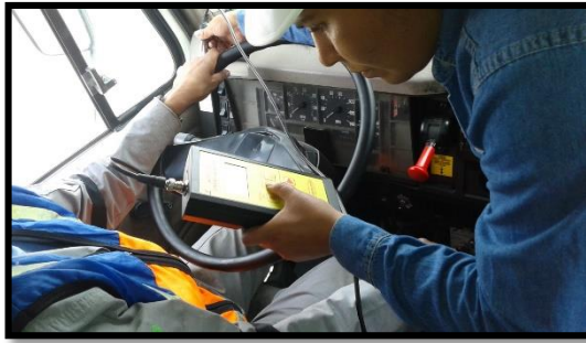
Fotografía 87. Medición Vibración mano brazo (izquierdo) eje z (Operario 10).
