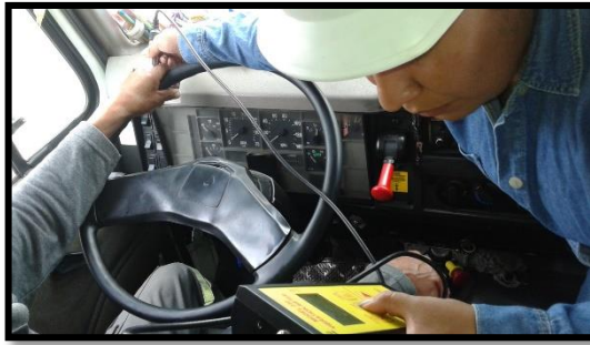
Fotografía 78. Medición Vibración mano brazo (izquierdo) eje z (Operario 9).
