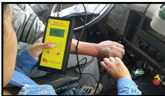
Fotografía 65. Medición Vibración mano brazo (derecho) eje y (Operario 8).
