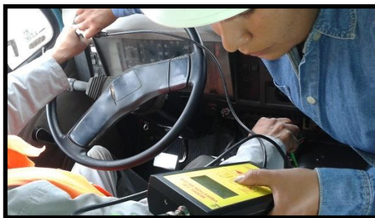
Fotografía 59. Medición Vibración mano brazo (izquierdo) eje y (Operario 7).
