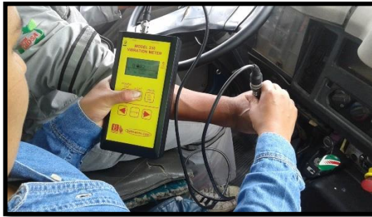
Fotografía 64. Medición Vibración mano brazo (derecho) eje x (Operario 8).
