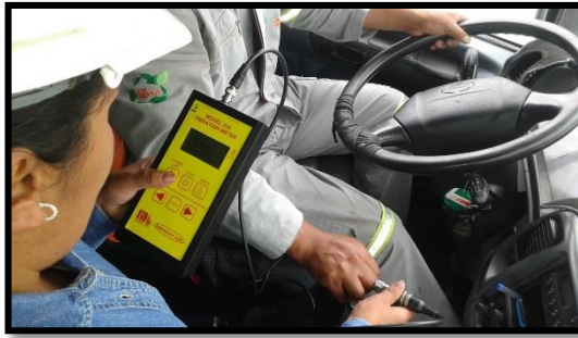
Fotografía 12. Medición Vibración mano brazo (derecho) eje z (Operario 2).
