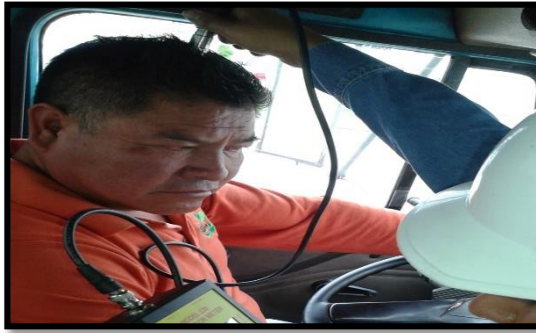
Fotografía 45. Medición Vibración cuerpo entero eje z (Operario 5).
