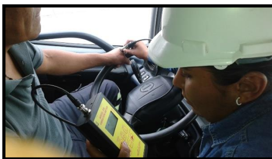
Fotografía 5. Medición Vibración mano brazo (izquierdo) eje y (Operario 1).
