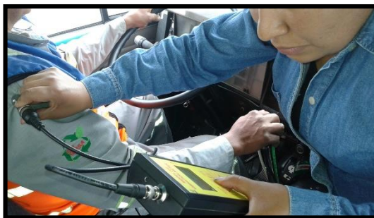
Fotografía 53. Medición Vibración cuerpo entero eje y (Operario 6).
