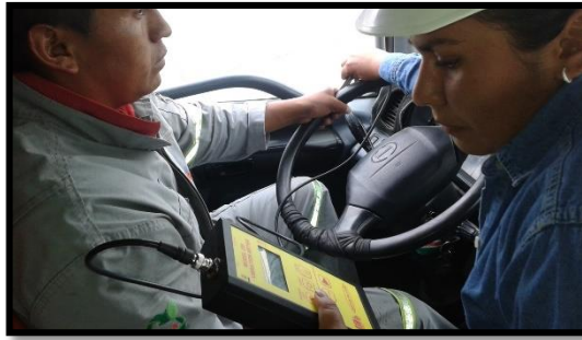
Fotografía 15. Medición Vibración mano brazo (izquierdo) eje z (Operario 2).
