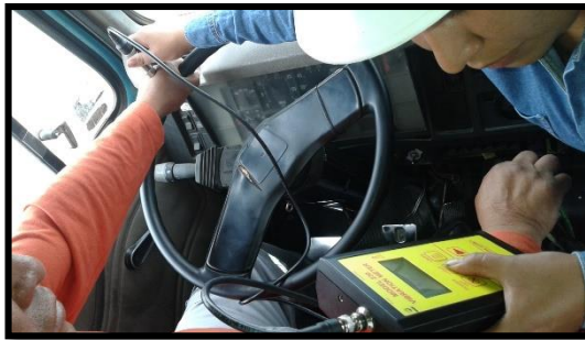
Fotografía 40. Medición Vibración mano brazo (izquierdo) eje x (Operario 5).
