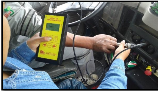
Fotografía 66. Medición Vibración mano brazo (derecho) eje z (Operario 8).
