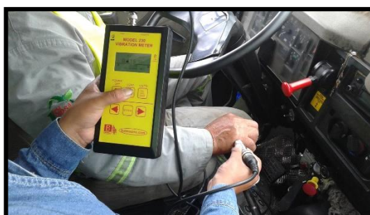
Fotografía 92. Medición Vibración mano brazo (derecho) eje y (Operario 11).
