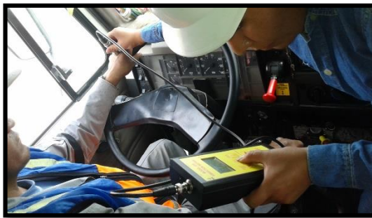
Fotografía 85. Medición Vibración mano brazo (izquierdo) eje x (Operario 10).
