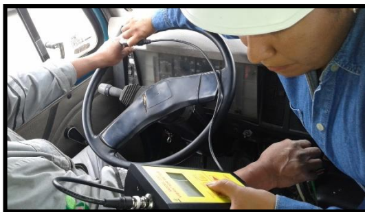
Fotografía 68. Medición Vibración mano brazo (izquierdo) eje y (Operario 8).
