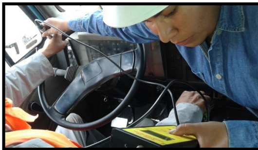
Fotografía 58. Medición Vibración mano brazo (izquierdo) eje x (Operario 7).
