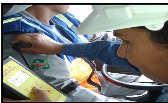
Fotografía 89. Medición Vibración cuerpo entero eje y (Operario 10).
