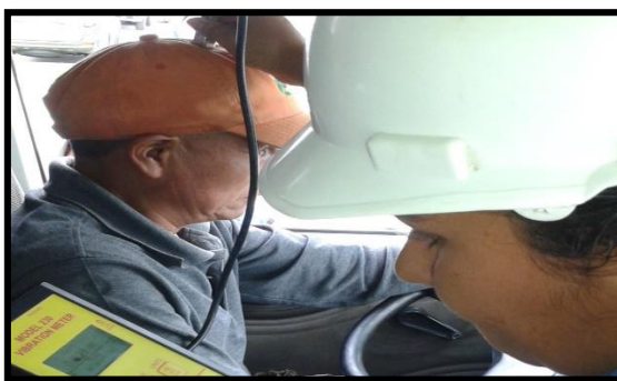
Fotografía 81. Medición Vibración cuerpo entero eje z (Operario 9).
