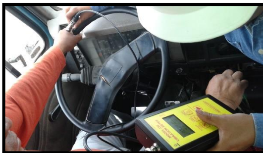
Fotografía 41. Medición Vibración mano brazo (izquierdo) eje y (Operario 5).
