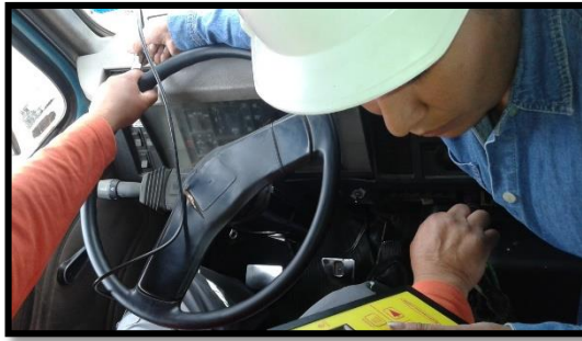
Fotografía 42. Medición Vibración mano brazo (izquierdo) eje z (Operario 5).
