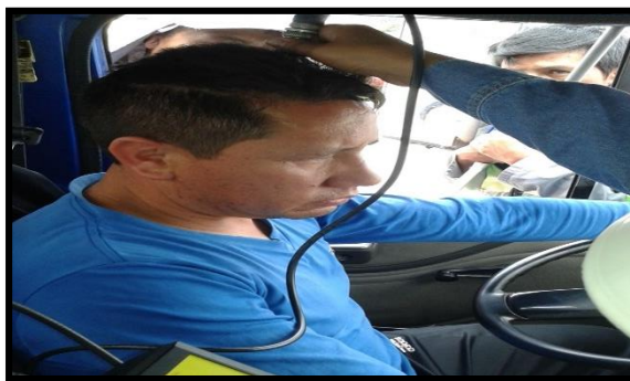
Fotografía 108. Medición Vibración cuerpo entero eje z (Operario 12).
