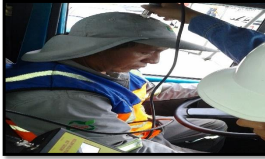
Fotografía 54. Medición Vibración cuerpo entero eje z (Operario 6).
