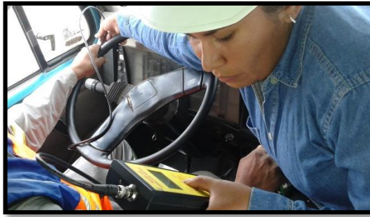
Fotografía 51. Medición Vibración mano brazo (izquierdo) eje z (Operario 6).
