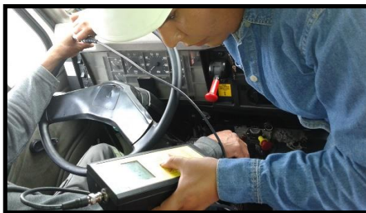
Fotografía 77. Medición Vibración mano brazo (izquierdo) eje y (Operario 9).
