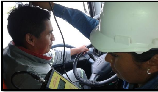
Fotografía 18. Medición Vibración cuerpo entero eje z (Operario 2).
