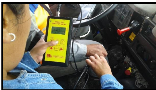
Fotografía 83. Medición Vibración mano brazo (derecho) eje y (Operario 10).
