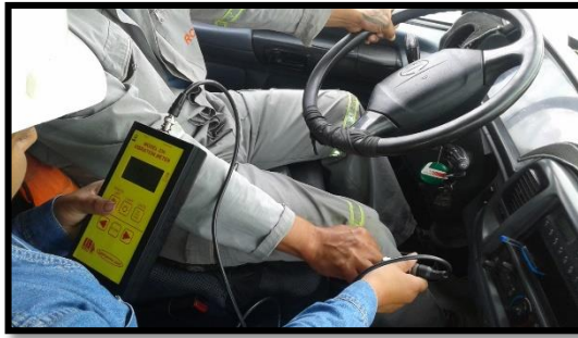
Fotografía 30. Medición Vibración mano brazo (derecho) eje z (Operario 4).
