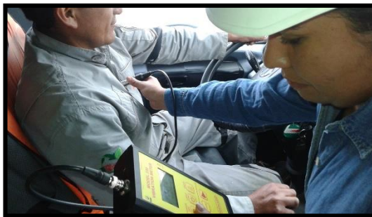
Fotografía 25. Medición Vibración cuerpo entero eje x (Operario 3).
