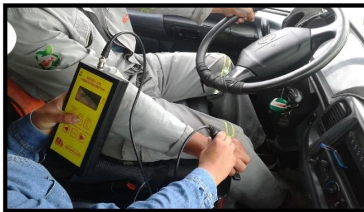
Fotografía 28. Medición Vibración mano brazo (derecho) eje x (Operario 4).
