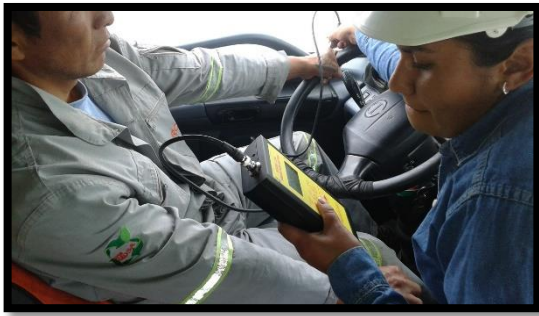
Fotografía 33. Medición Vibración mano brazo (izquierdo) eje z (Operario 4).
