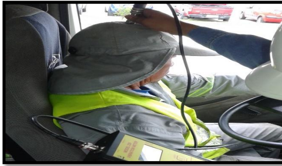
Fotografía 99. Medición Vibración cuerpo entero eje z (Operario 11).
