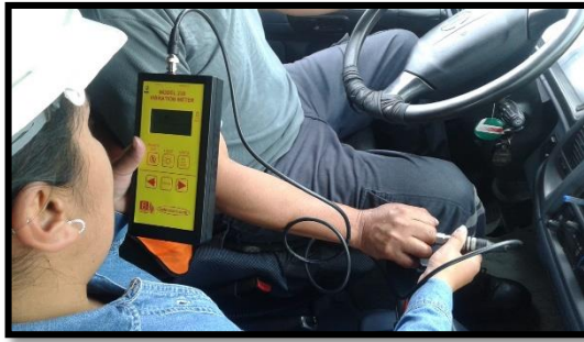
Fotografía 3. Medición Vibración mano brazo (derecho) eje z (Operario 1).
