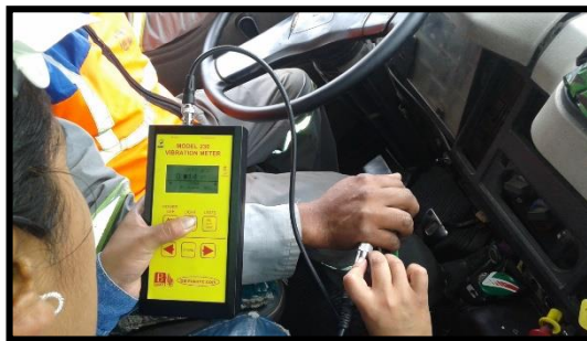
Fotografía 47. Medición Vibración mano brazo (derecho) eje y (Operario 6).
