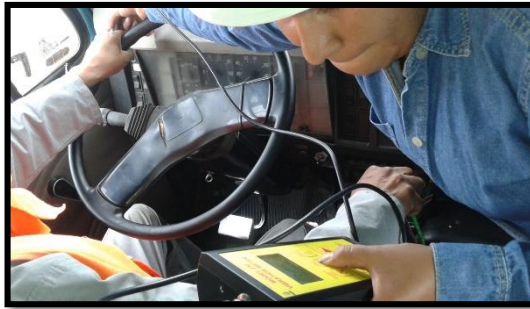
Fotografía 60. Medición Vibración mano brazo (izquierdo) eje z (Operario 7).
