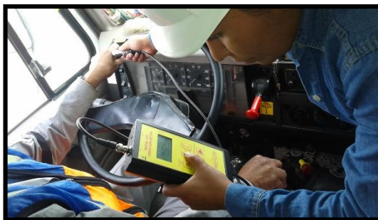
Fotografía 86. Medición Vibración mano brazo (izquierdo) eje y (Operario 10).
