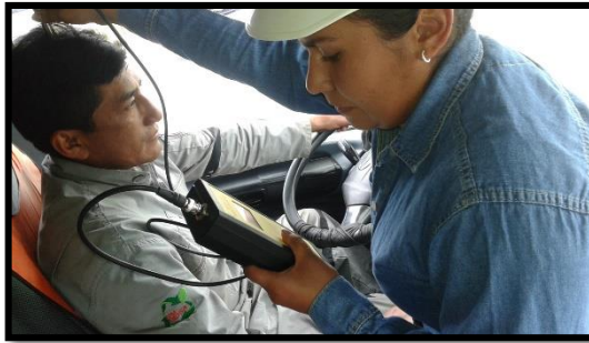
Fotografía 36. Medición Vibración cuerpo entero eje z (Operario 4).
