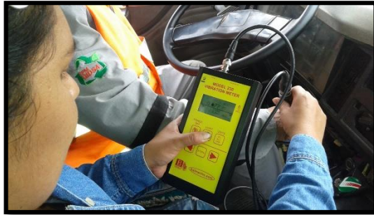
Fotografía 55. Medición Vibración mano brazo (derecho) eje x (Operario 7).
