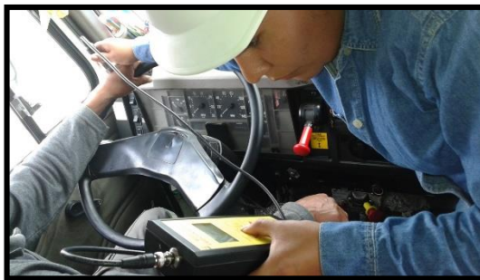
Fotografía 76. Medición Vibración mano brazo (izquierdo) eje x (Operario 9).
