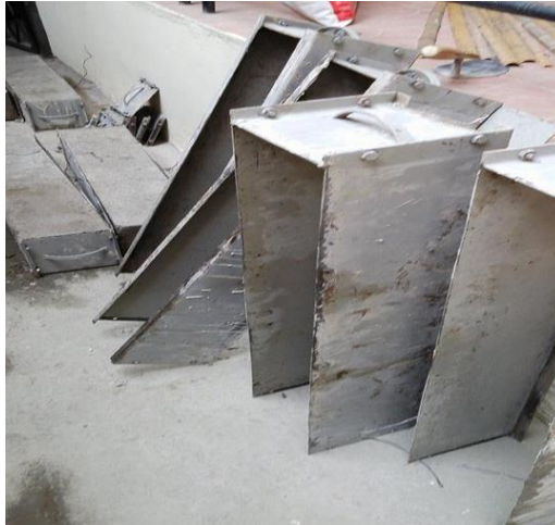
GRÁFICO 44.-Encofrado para Vigas con Acero, Bambú y Caña Guadúa
