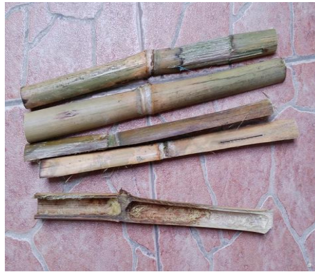
GRÁFICO 41 Tiras cortadas de Bambú Colocadas el Plastificante “MADEROL CONCENTRADO”
